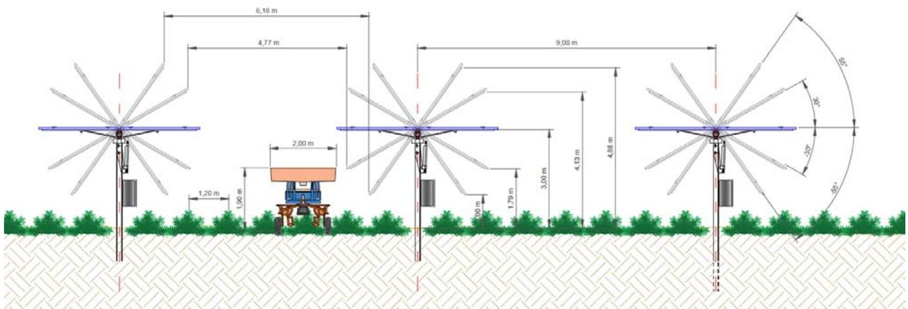
Figura 5-14 - Particolare costruttivo in sezione delle strutture di sostegno dei moduli fotovoltaici
