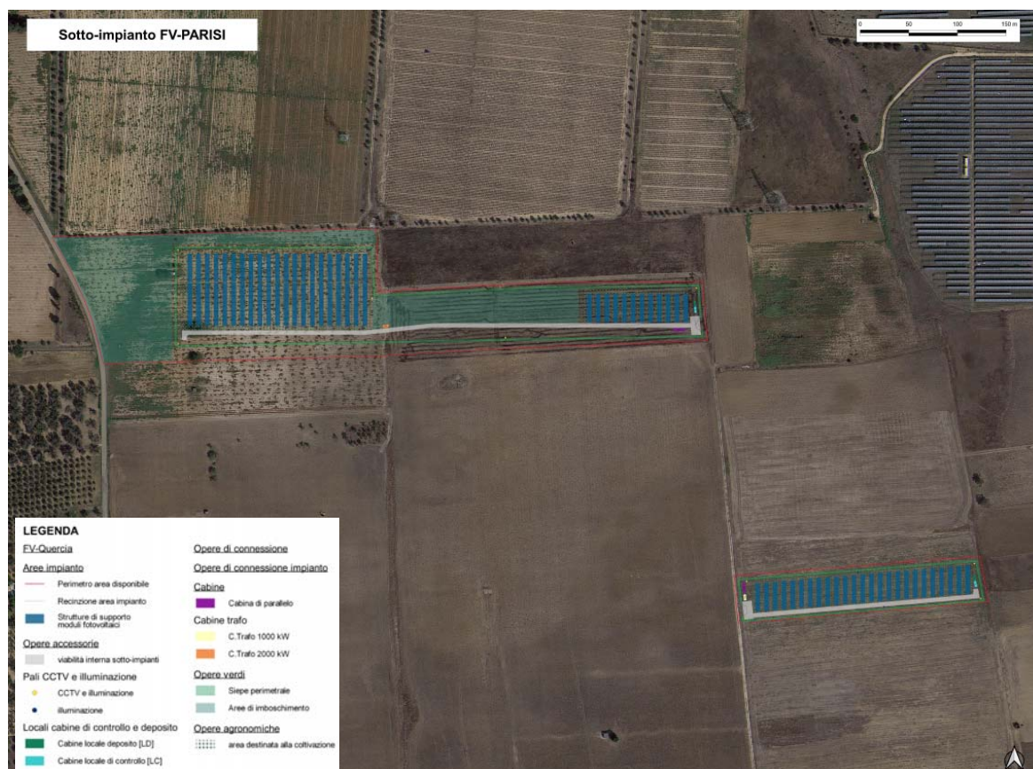
Figura 6-11 - Layout agro-fotovoltaico sotto-impianto FV-Parisi
