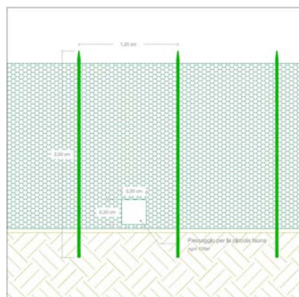
Figura 7-2 - Particolare recinzione passaggio piccola fauna
