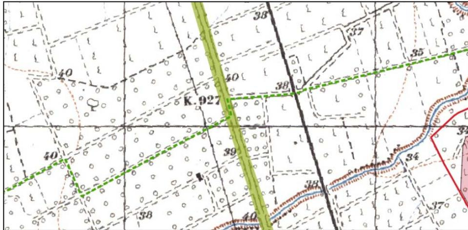
Figura 2-16 - Dettaglio inquadramento delle opere di connessione (Cavidotto MT di parallelo interrato su Strada Statale 16) PPTR - Carta della Struttura antropica e storico-culturale – Componenti dei valori percettivi (non in scala)
