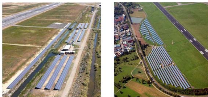
Figura 3-4 - Esempi di impianti fotovoltaici in ambito aeroportuale. La disposizione dei moduli fotovoltaici in prossimità delle piste di atterraggio/decollo non rappresenta un rischio per la sicurezza
