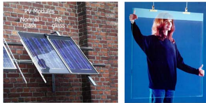
Figura 3-3 - Le due immagini dimostrano in modo lampante come, al contrario di un vetro comune (normal glass), il vetro anti-riflesso (Anti- Reflecting glass) che riveste i moduli fotovoltaici (Photo Voltaic Modules) riduca drasticamente la riflessione dei raggi luminosi
