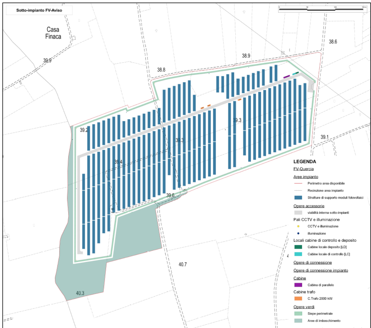
Figura 4-15 - Inquadramento su CTR del sotto-impianto FV-Aviso
