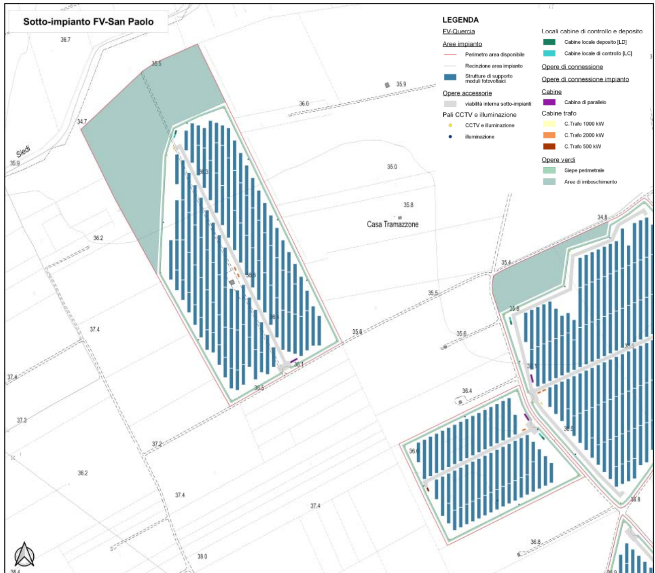
Figura 4-12 - Inquadramento su CTR del sotto-impianto FV-San Paolo
