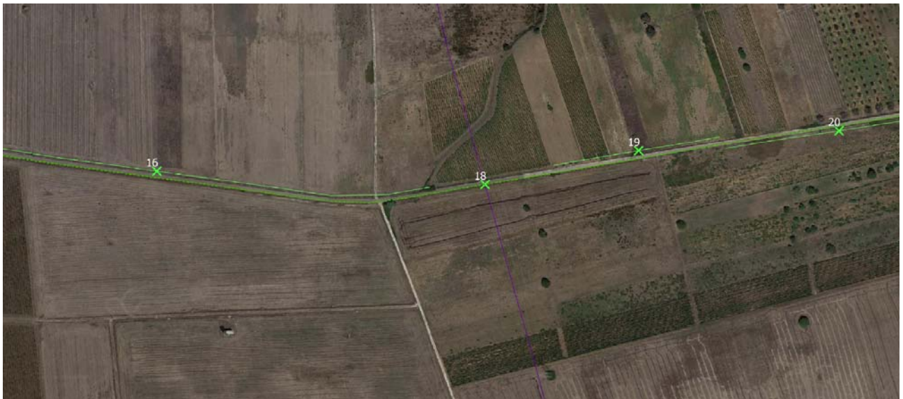
Figura 3-20 Interferenza tra la linea area TLC e il cavidotto di parallelo interrato (punti n°16, n°19 e n°20); interferenza di attraversamento tra la linea aerea AT e il cavidotto di parallelo interrato (punto n°18) – non rilevanti
