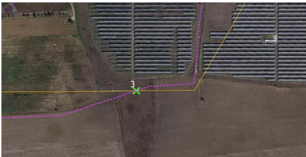
Figura 3-16 Interferenza di attraversamento tra la linea area MT e la dorsale interrata – non rilevante
