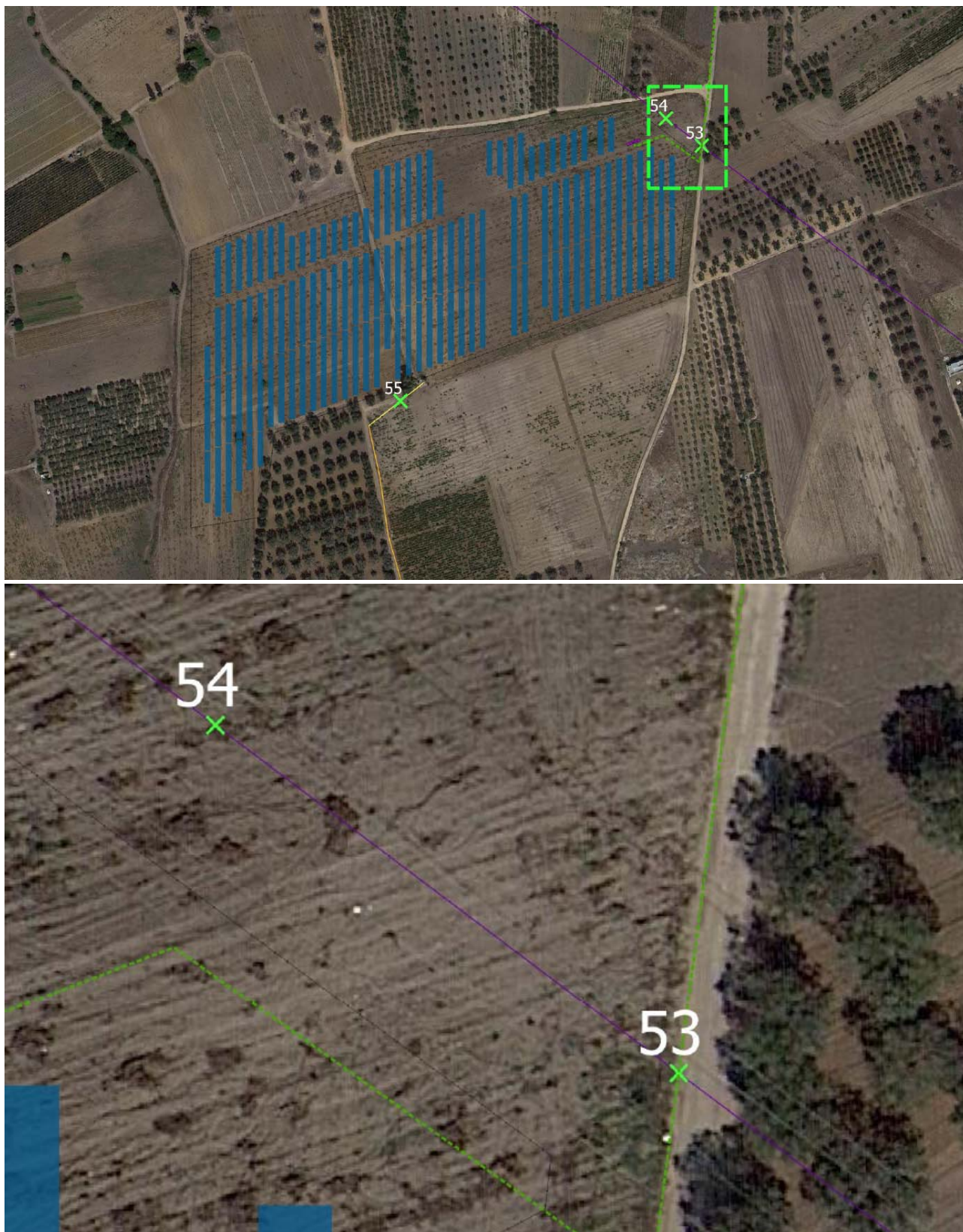
Figura 3-26 - Interferenza tra la linea aerea AT e le strutture di supporto dei moduli fotovoltaici (punto n°54); interferenza di attraversamento tra la linea aerea AT e il cavidotto di parallelo interrato (punto n°53); interferenza tra la linea aerea BT e le strutture di supporto dei moduli fotovoltaici (punto n°55) – non rilevanti
