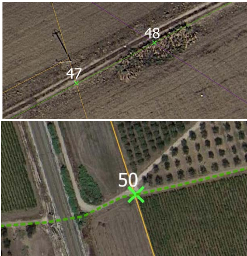
Figura 3-25 Interferenza di attraversamento tra la linea aerea MT e il cavidotto di parallelo interrato (punto n°47 e n°50); interferenza di attraversamento tra la linea aerea AT e il cavidotto di parallelo interrato (punto n°48) – non rilevanti
