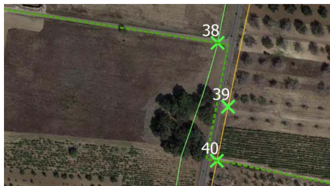
Figura 3-23 Interferenza di attraversamento tra la linea aerea TLC e il cavidotto di parallelo interrato (punto n°38); interferenza di fiancheggiamento e di attraversamento tra la linea aerea MT e il cavidotto di parallelo interrato (punto n°39 e n°40) – non rilevanti
