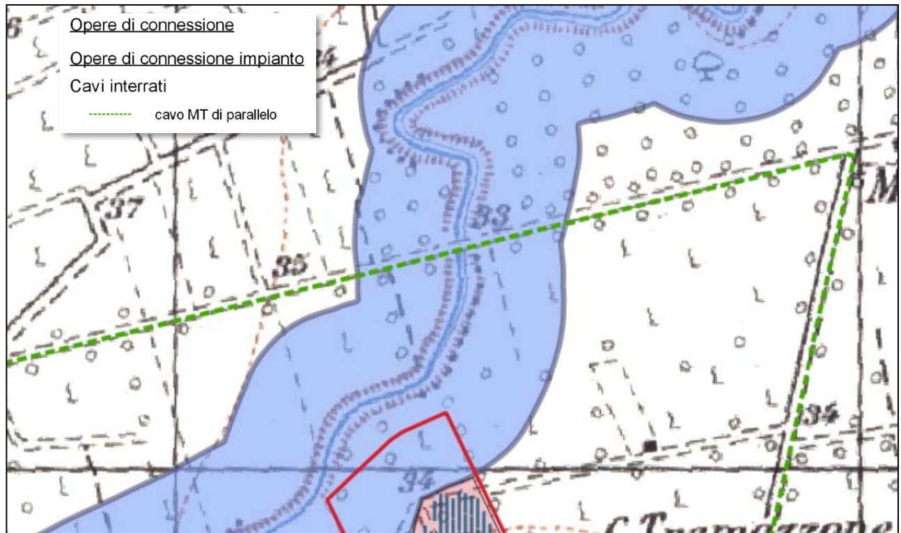
Figura 2-3 - Inquadramento delle opere di connessione (Cavidotto MT di parallelo interrato su Strada Provinciale 81) su PPTR - Carta della Struttura Idrogeomorfologica – Componenti idrologiche
