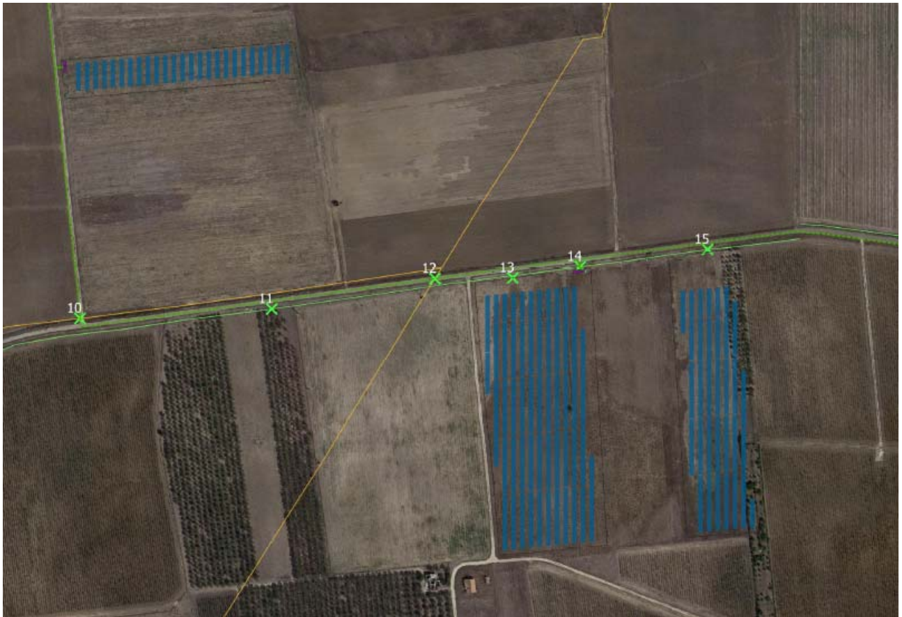
Figura 3-19 - Interferenza tra la linea area MT e il cavidotto di parallelo interrato (punti n°10, n°11, n°12 e n°14); interferenza di fiancheggiamento e attraversamento tra la linea aerea TLC e la recinzione (punto n°3 e n°15) – non rilevanti
