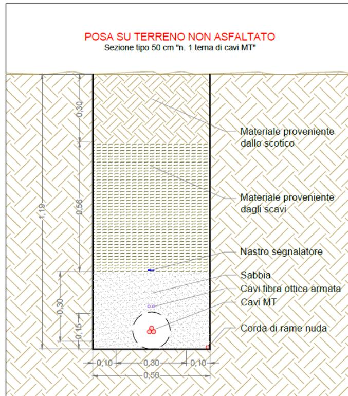
Figura 4-13 - Esempio di posa cavi MT interrati su terreno agricolo
