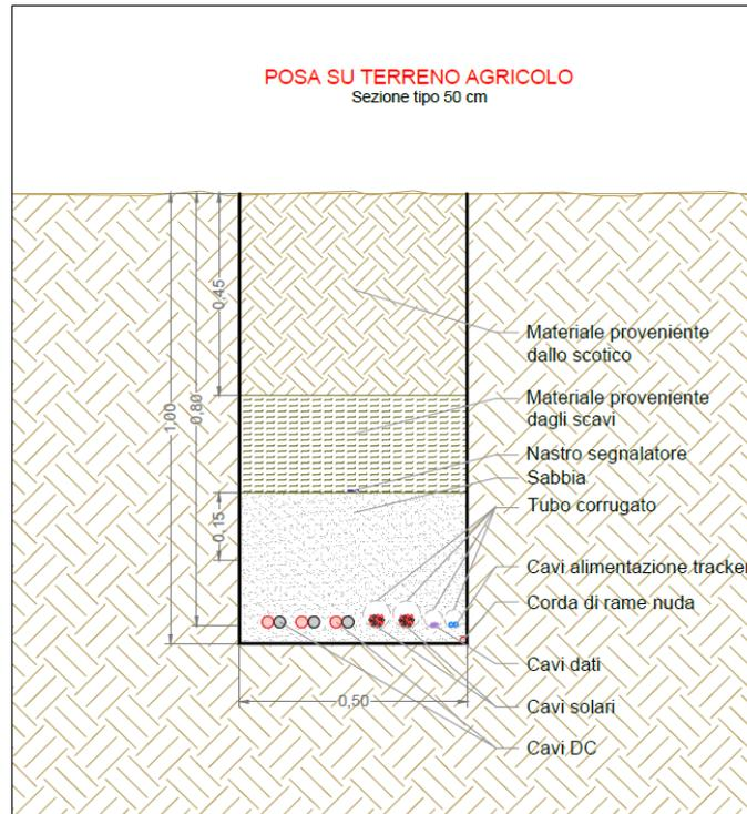
Figura 4-11 - Esempio di posa cavi BT interrati su terreno agricolo
