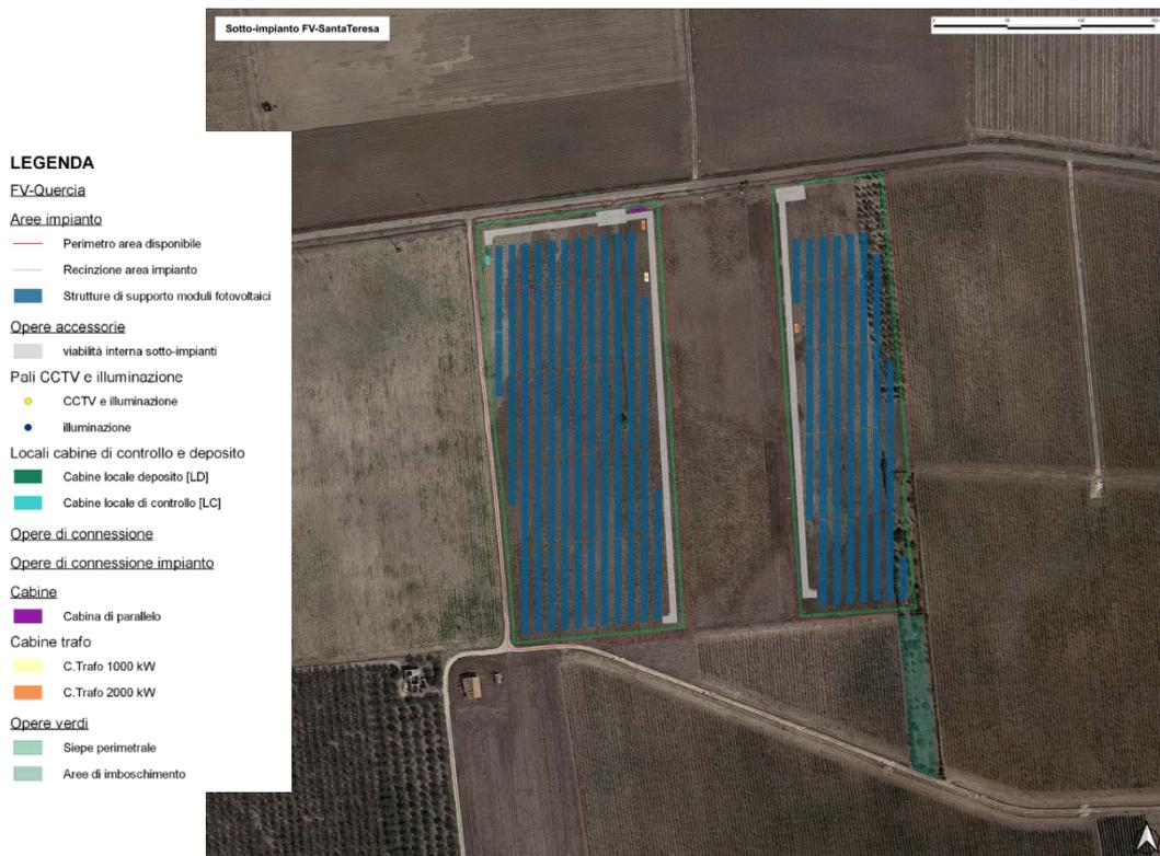
Figura 3-4 - Ortofoto sotto-impianto FV-Santa Teresa (fonte dell'ortofoto: google earth anno di acquisizione dell'immagine 2021)
