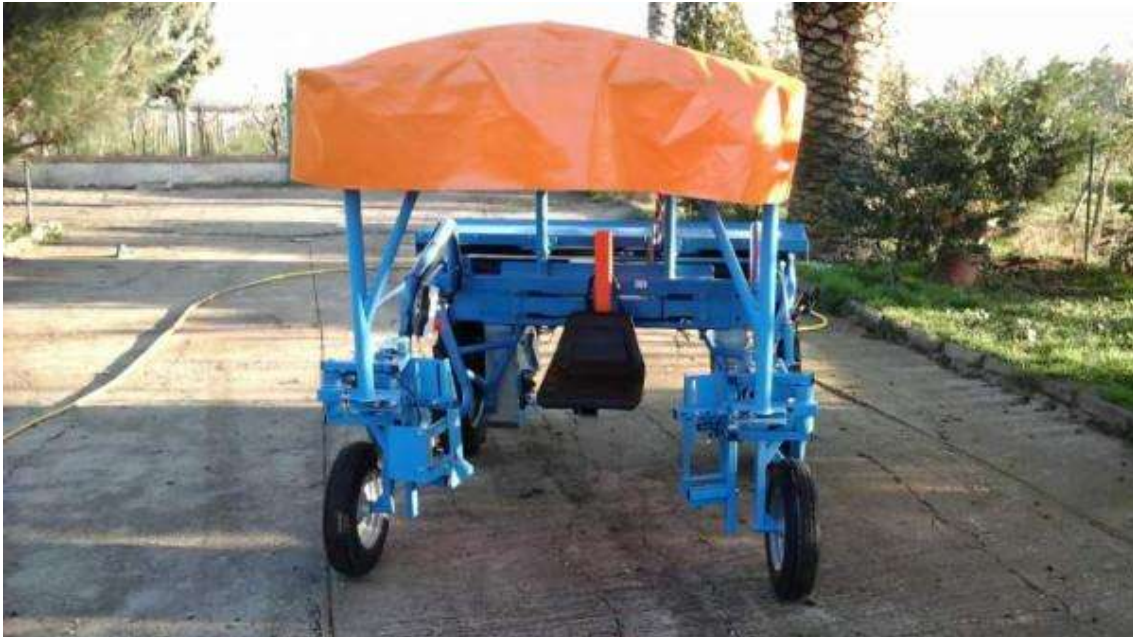
63 - esempio di macchina agevolatrice nella raccolta del carciofo: maggiore efficienza e riduzione dei costi di raccolta del 30%
