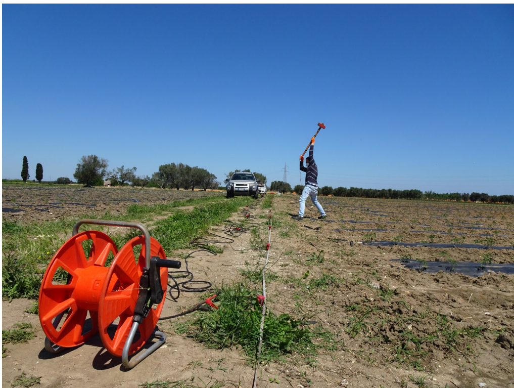
Foto 2: Fase di esecuzione della MASW 2
