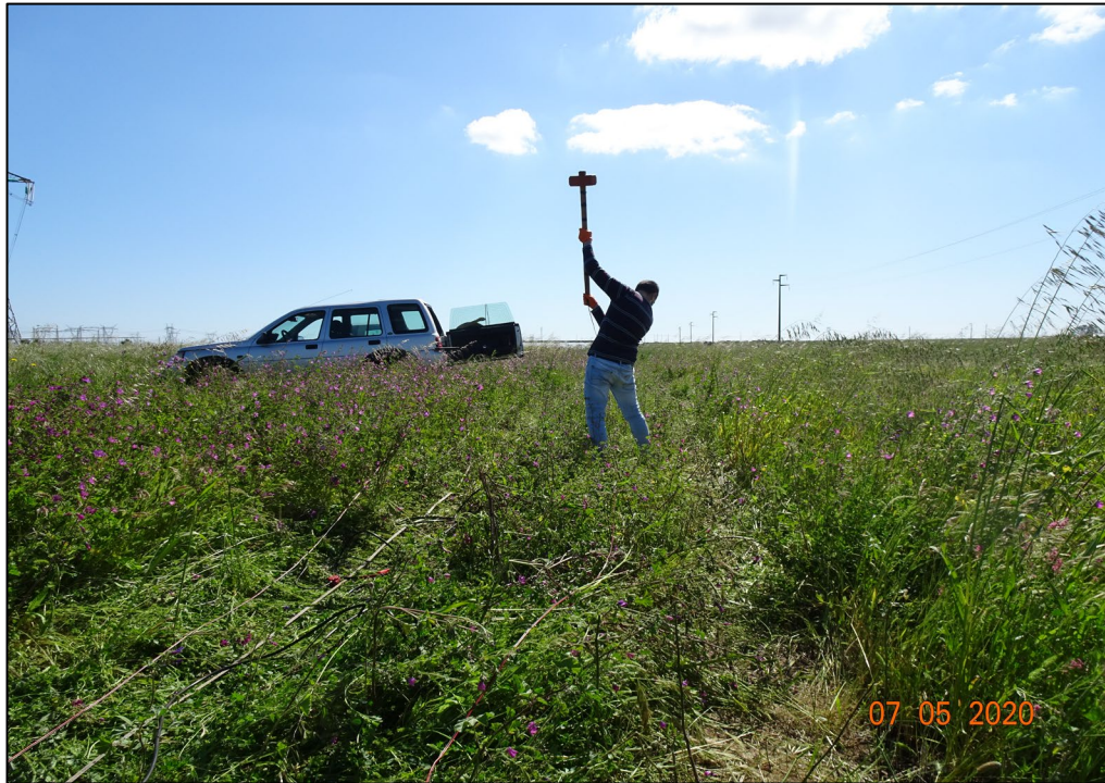
Foto 1: Fase di esecuzione della MASW 1
