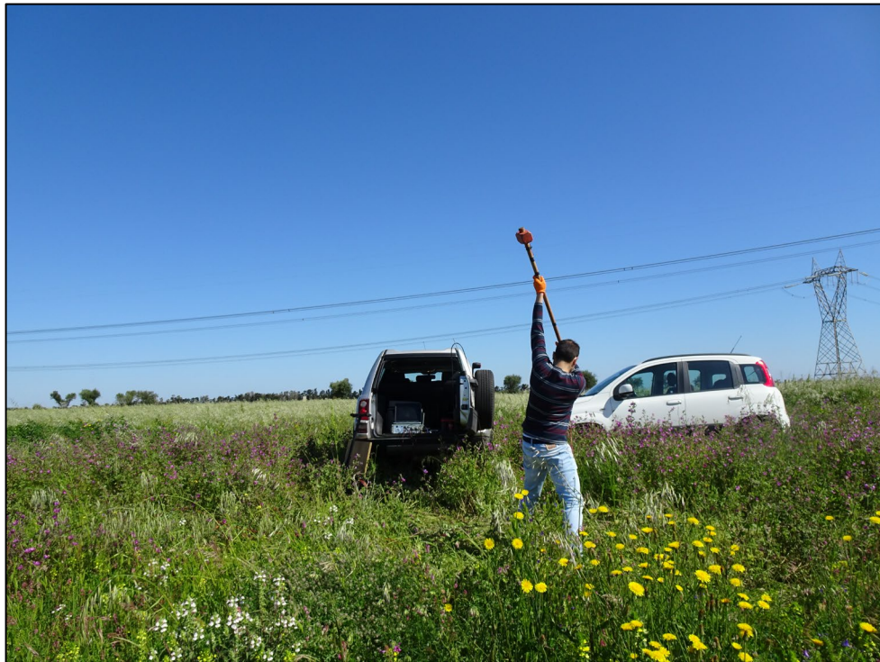
Foto 2: Fase di esecuzione della Rifrazione 1 (A-A')
