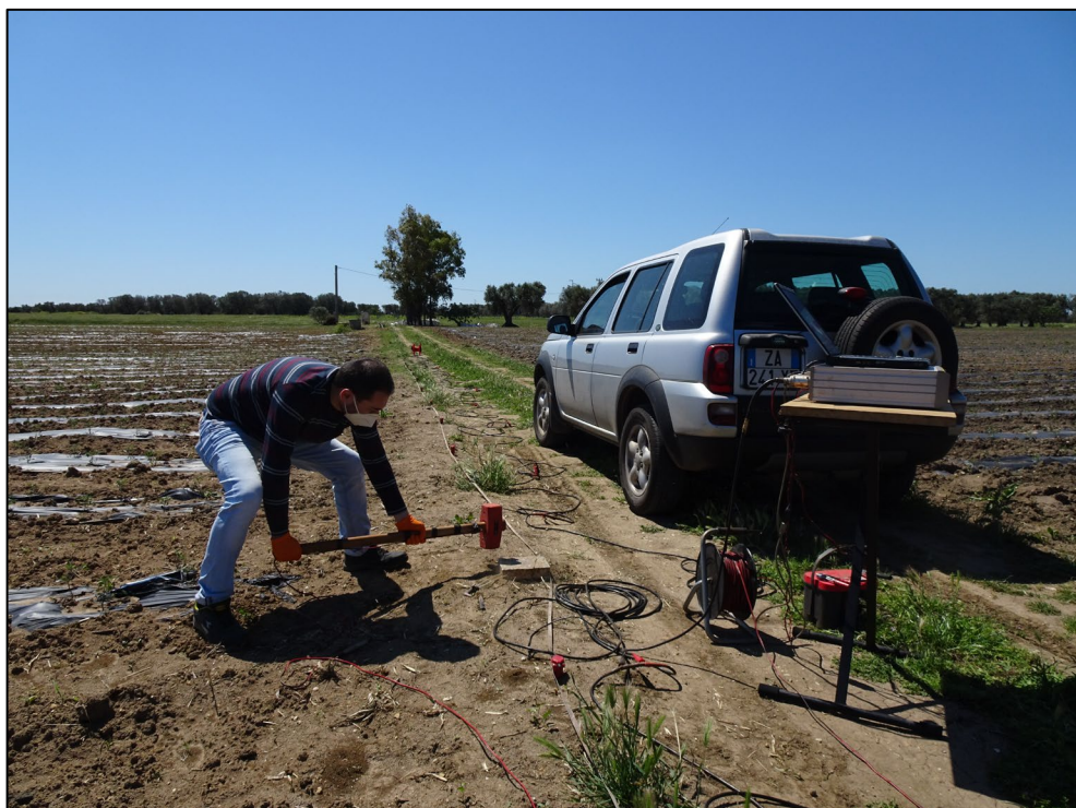
Foto 4: Fase di esecuzione della Rifrazione 2 (B-B')
