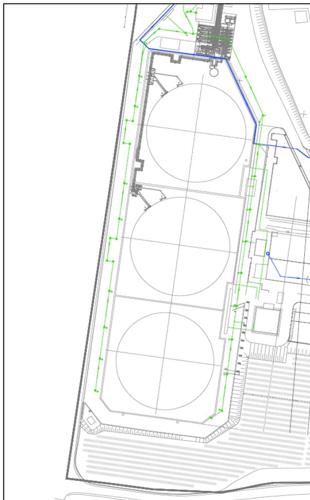
**Figura 36** - Attuale configurazione reti di scarico nell'area serbatoi esistente
