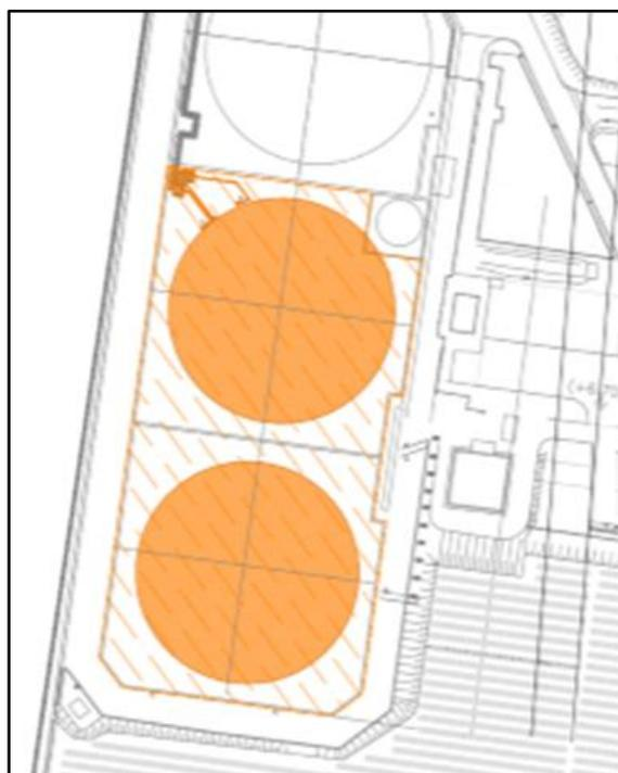
**Figura 29** – Demolizioni fondazioni esistenti propedeutiche all'installazione del nuovo impianto
