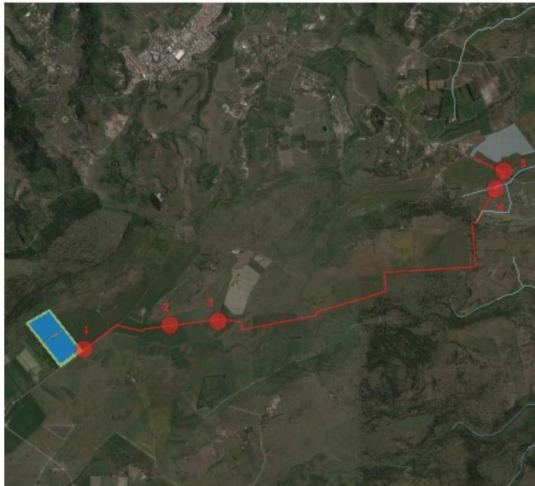
Figura 6 – individuazione interferenza percorso cavidotto in MT
