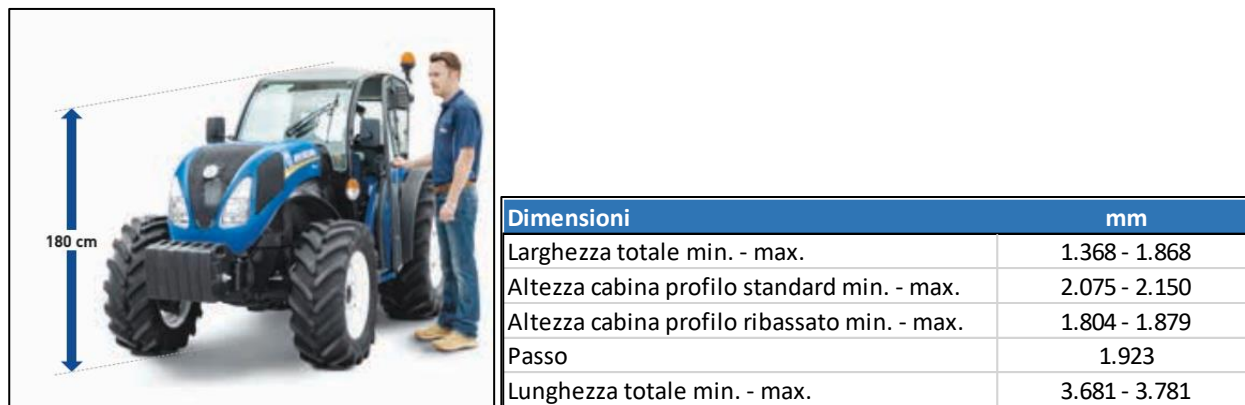
Figura 5.5: Dimensioni caratteristiche di un trattore da frutteto con cabina ribassata (Fonte: CNH)
