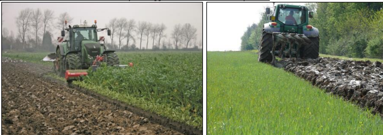
Fig. 5.3: Esempio di pratica del sovescio in pieno campo. Si noti, nell’immagine a sinistra, l’impiego di una trincia frontale montata sulla stessa trattore per alleggerire il carico sull’aratro portato
