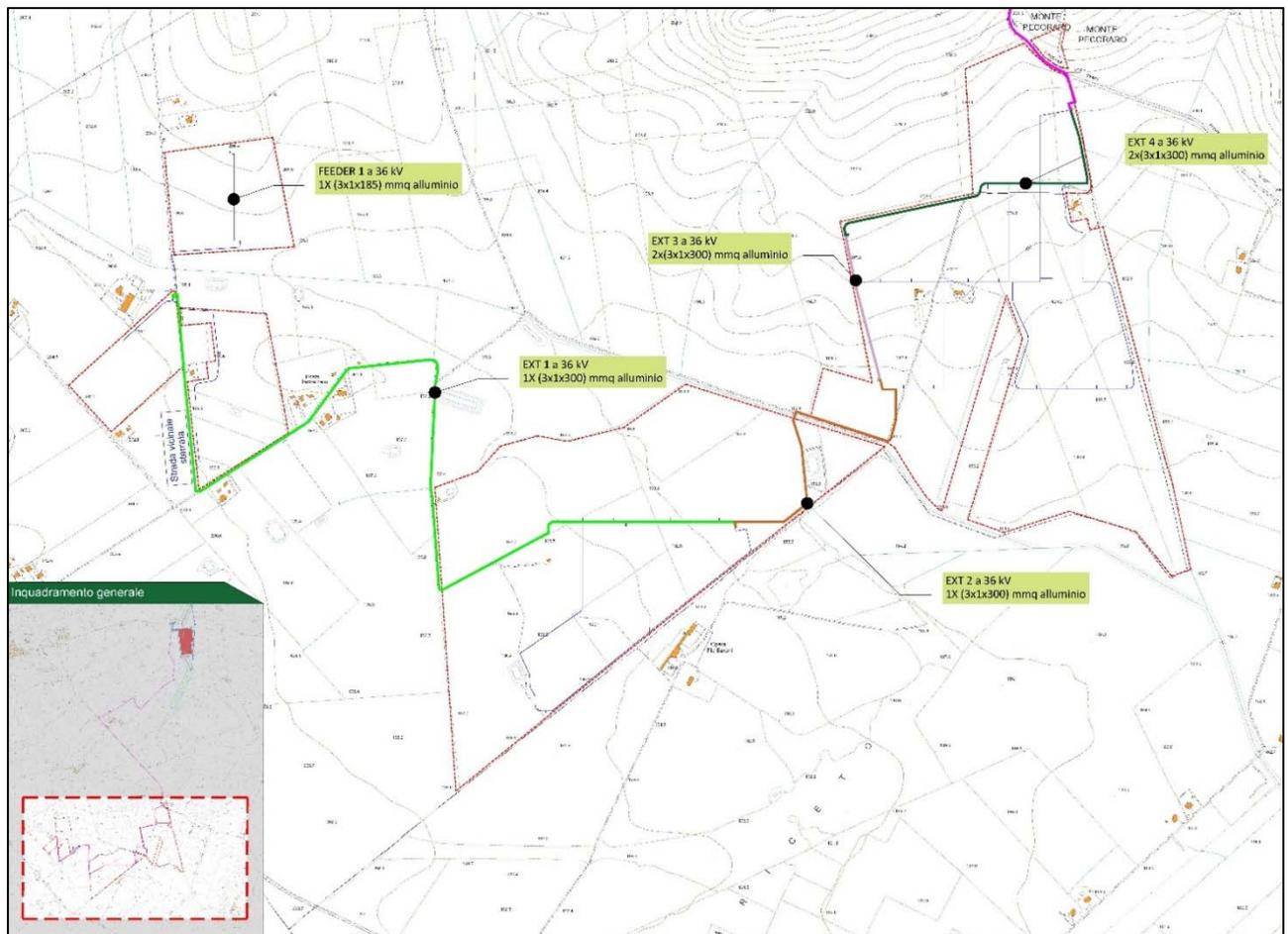
**Figura 3 - Inquadramento tratti cavidotti di collegamento ext 1-2-3-4**
