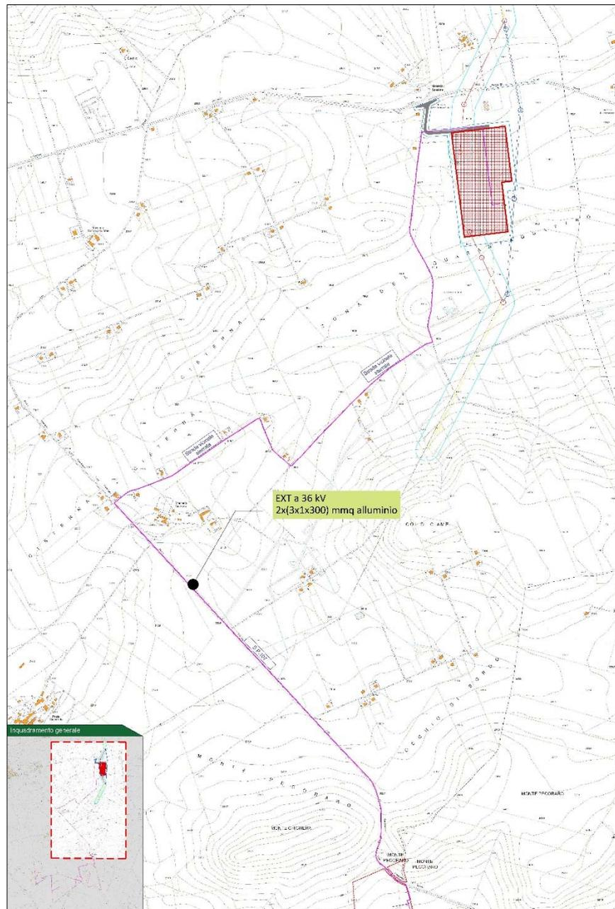
**Figura 4 - Inquadramento tratto cavidotto di connessione ext a 36 kV**
