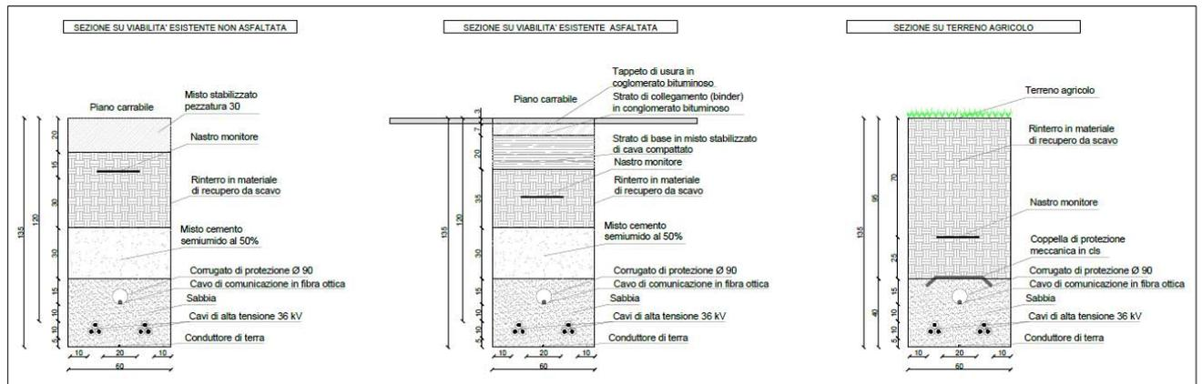
Figura 5 - Sezione tipo scavo trincea cavidotto AT a 36 kV (2 terne)
