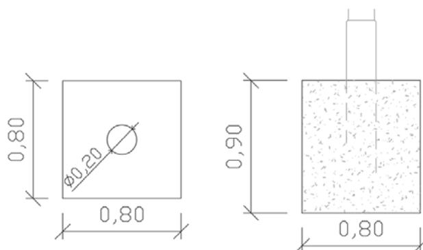
**Figura 7 - Particolare costruttivo dello scavo dei pali di videosorveglianza**
