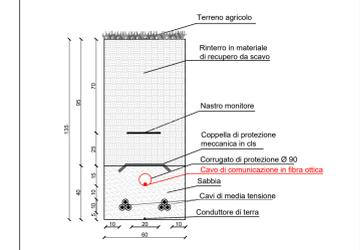
SEZIONE TIPO SU VIABILITA' ESISTENTE NON ASFALTATA
