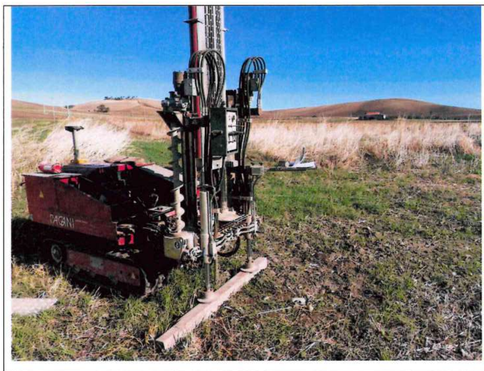
Esecuzione prova DPSH 5
