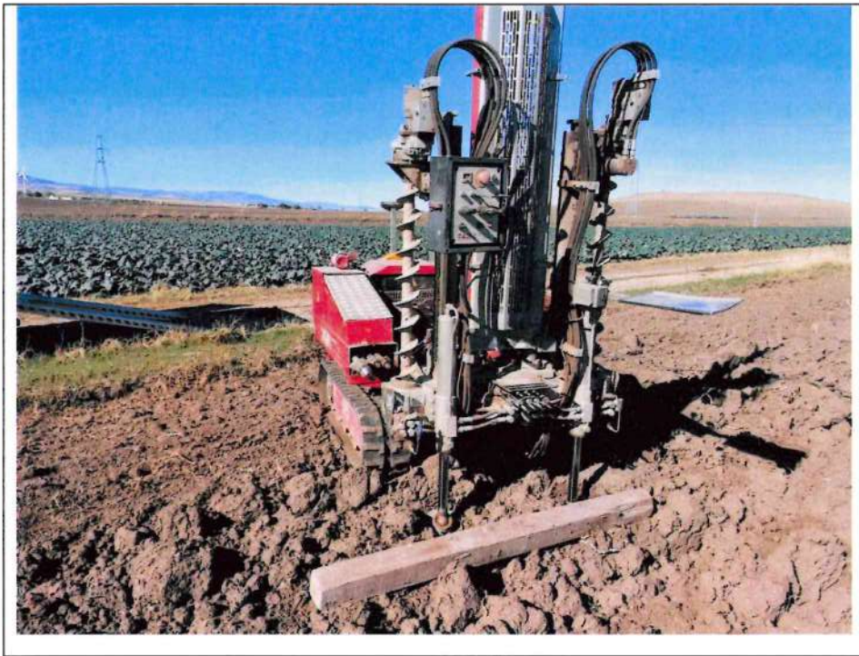
Esecuzione prova DPSH 1
