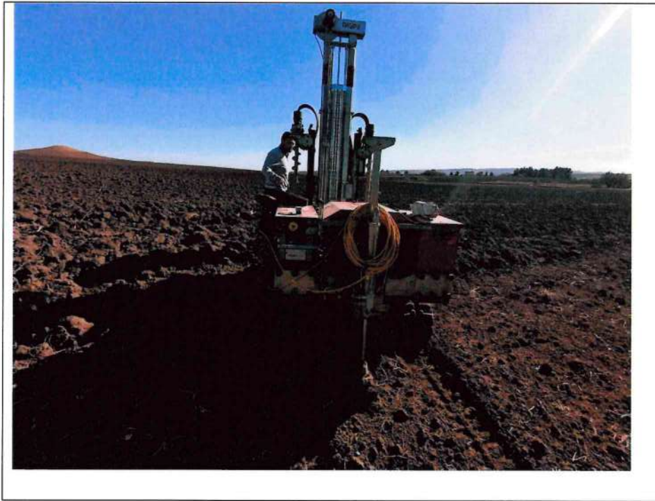
Esecuzione prova DPSH 3
