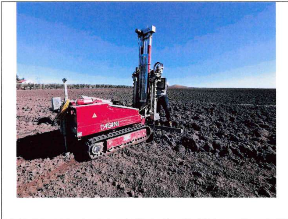
Esecuzione prova DPSH 2
