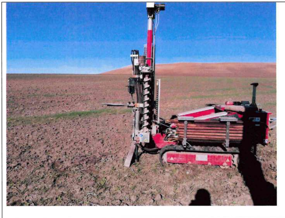
Esecuzione prova DPSH 8
