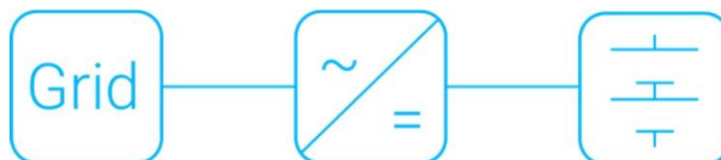
Schema semplificato di un convertitore monostadio
