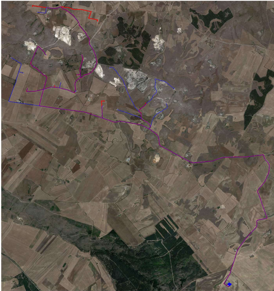
Fig. 5 Tracciato elettrodotti impianto esistente (colore blu) e dell'impianto di progetto (colore rosso)
