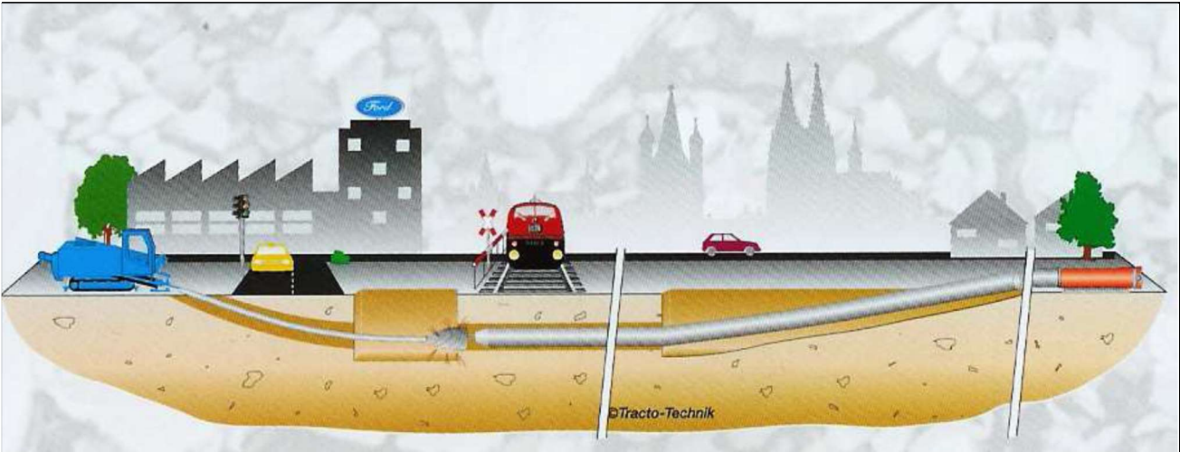
Fig. 28. Schema di principio dell'attraversamento in T.O.C.
