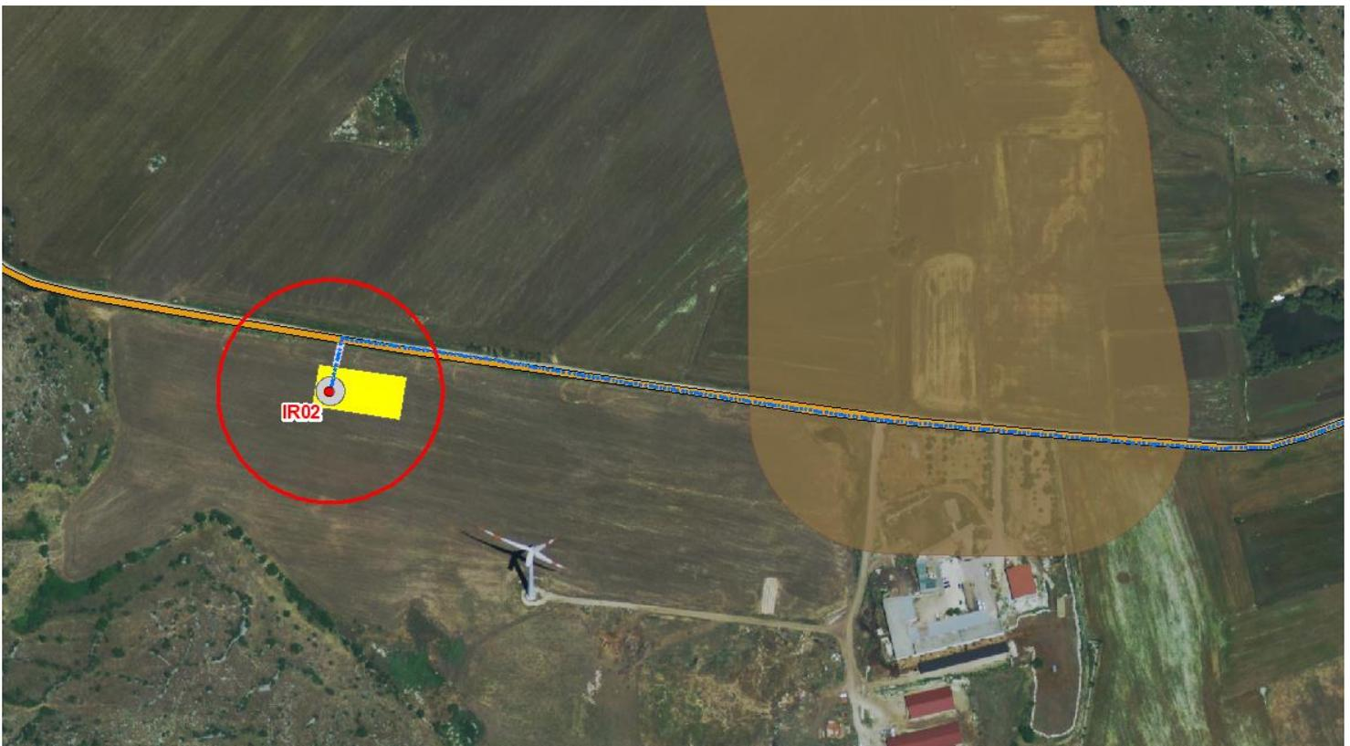
*Figura 5. Dettaglio interferenza Cavidotto interno MT su Aree Tutelate per legge (art. 142 D.Lgs.42/'04) - Tratturi con buffer di 100 m. - Trattarello Montecarafa – Minervino*
