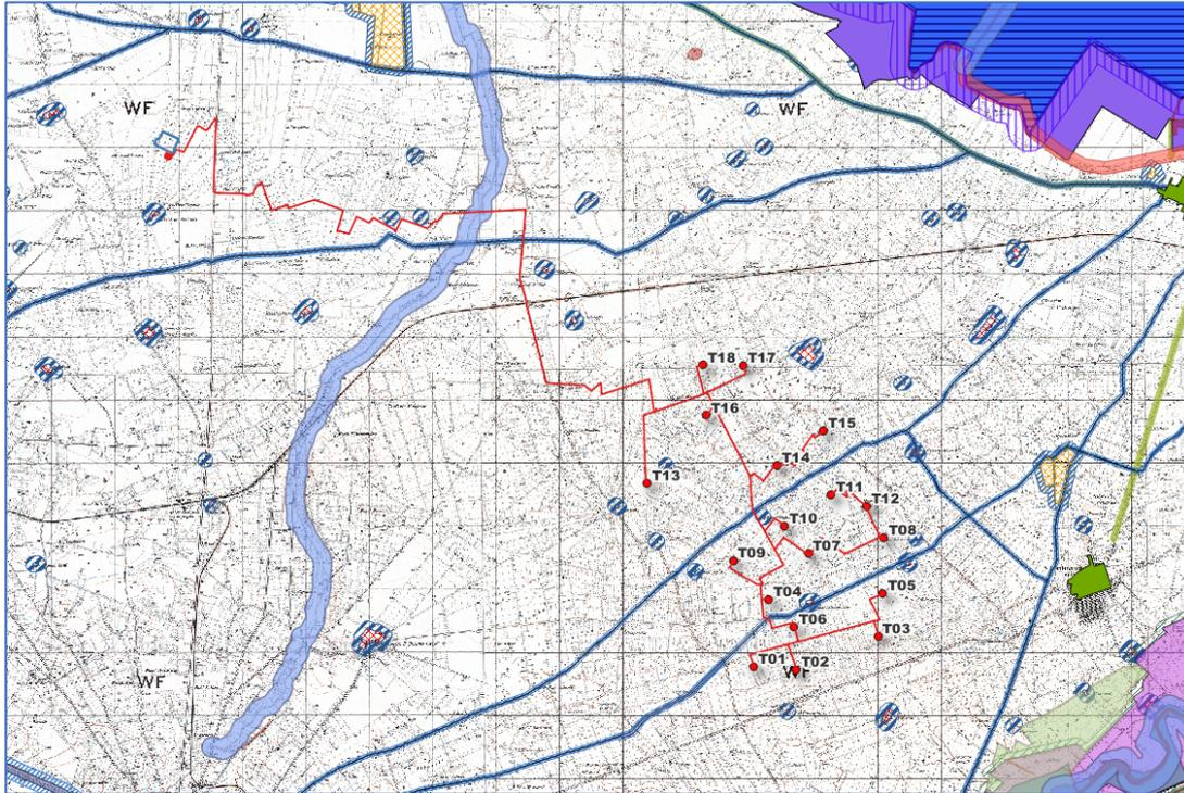
Figura 8 - Stralcio delle aree tutelate dal PPTR Puglia – Aerogeneratori, viabilità e opere di connessione
