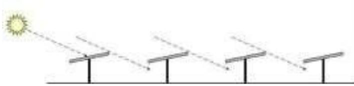
Seguendo un principio di standardizzazione del campo fotovoltaico si cercherà di limitare al massimo le tipologie di inseguitori, gestendoli in modo da garantire un cablaggio della parte in corrente continua omogeneo per tutto il sito. La lunghezza del singolo inseguitore sarà pertanto in funzione della lunghezza delle stringhe fotovoltaiche. Nello specifico sono state utilizzate strutture che permettono l'installazione di 24, 48 e 96 moduli fotovoltaici.
