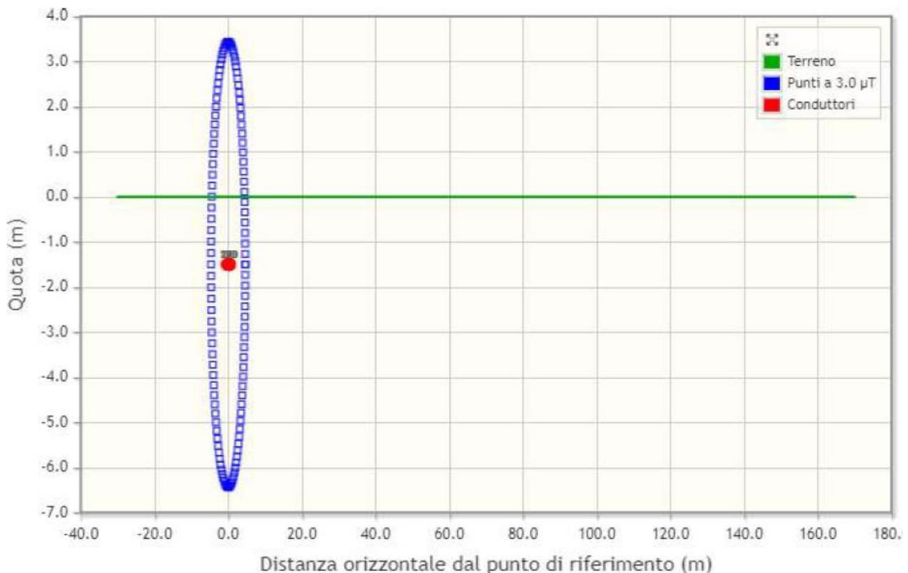
Si può quindi considerare che l'ampiezza della fascia di rispetto con valore del campo magnetico indotto inferiore a  $3\mu\text{T}$  sia pari a 3m, a cavallo dell'asse del cavidotto.
