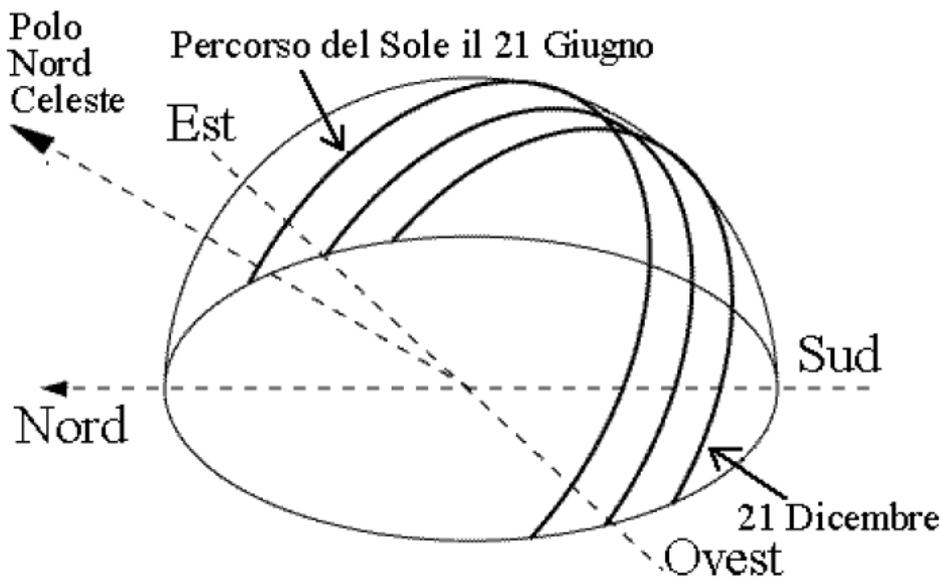
*Figura 7: Movimento apparente del disco solare per un osservatore situato ad una latitudine nord attorno ai 45°. Per tutte le località situate tra il Tropico del Cancro e il Polo Nord Geografico il disco solare non raggiunge mai lo zenit*
