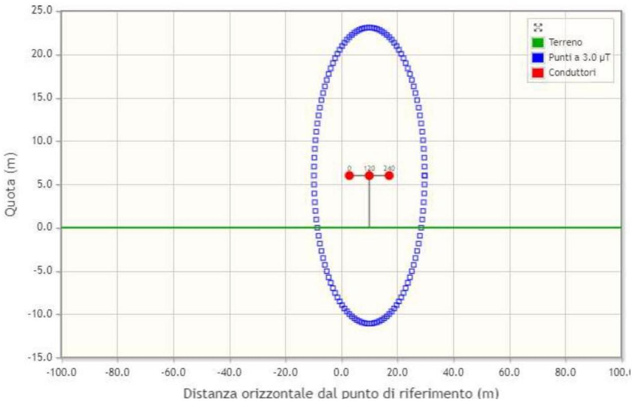
Come si può notare, ad una distanza di 20m dall'asse del sistema di sbarre l'induzione magnetica è inferiore a  $3\mu\text{T}$ , mentre a 10.5m siamo al di sotto dei  $10\mu\text{T}$ .
