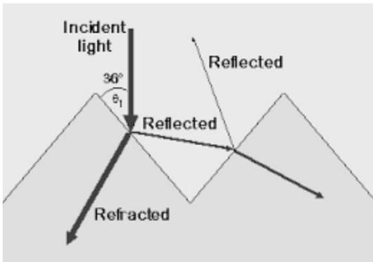
Figura 10: Percorso della luce su celle testurizzate
