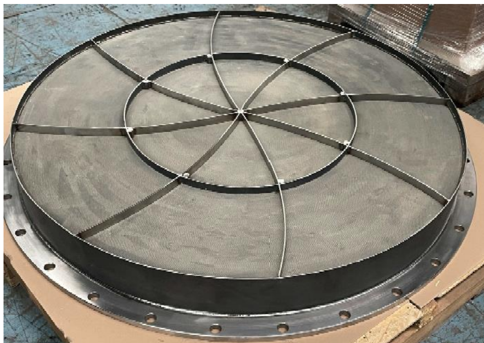
Figura 2.3 – foto del catalizzatore prototipo
