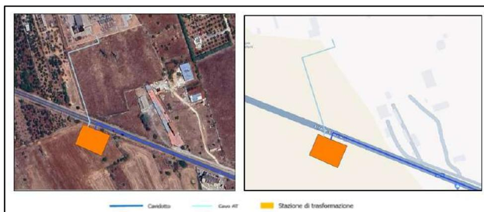
Figura 2-20 Cavo AT non ricadente su viabilità esistente
