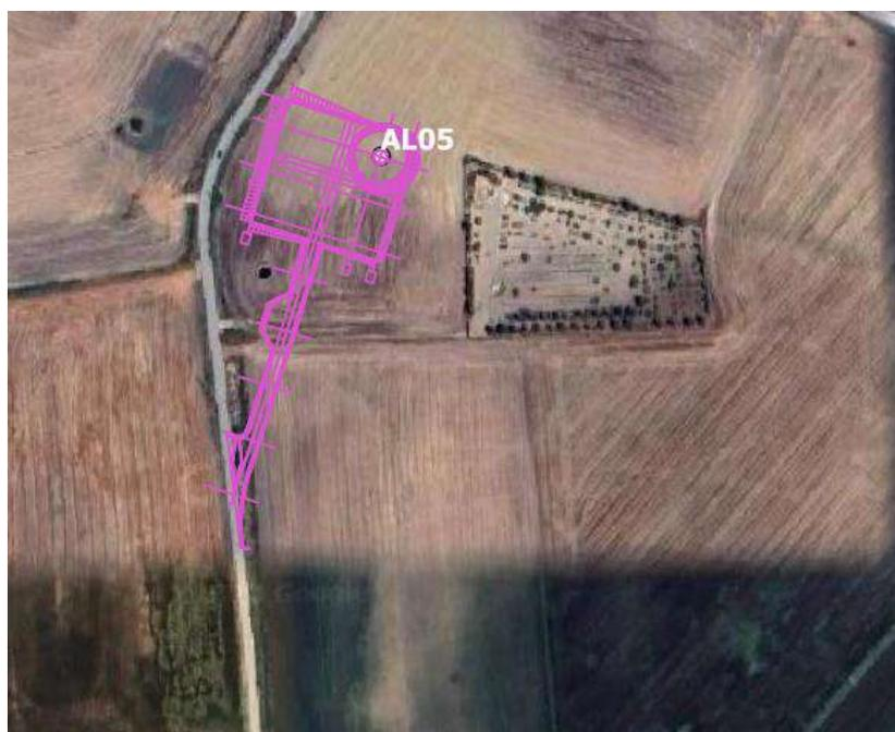
*Figura 2-37 Rappresentazione su immagine satellitare dell'impronta a terra della piazzola AL05, e della relativa strada di accesso, nella fase costruttiva*
