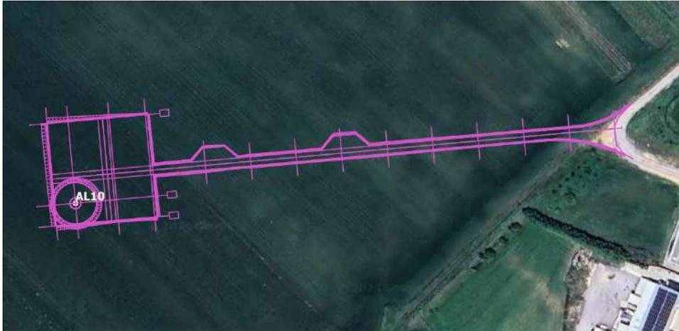
*Figura 2-15 Rappresentazione su immagine satellitare dell'impronta a terra della piazzola AL10 e della relativa strada di accesso, nella fase costruttiva*
