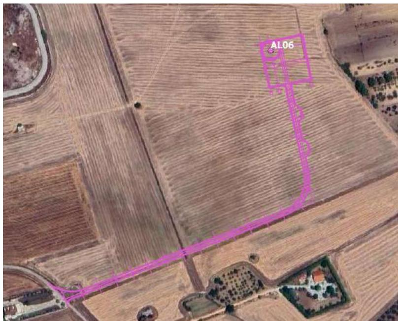
*Figura 2-11 Rappresentazione su immagine satellitare dell'impronta a terra della piazzola AL06, e della relativa strada di accesso, nella fase costruttiva*
