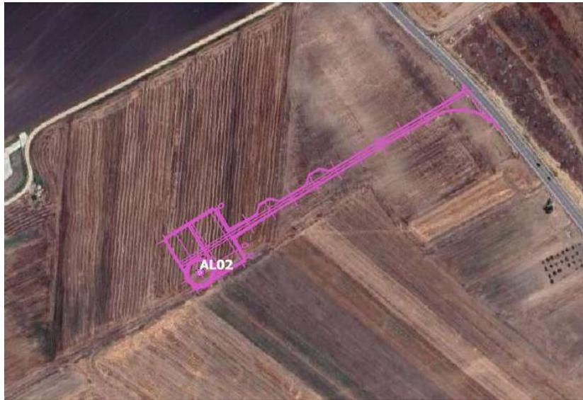
Figura 2-34 Rappresentazione su immagine satellitare dell'impronta a terra della piazzola AL02, e della relativa strada di accesso, nella fase costruttiva
