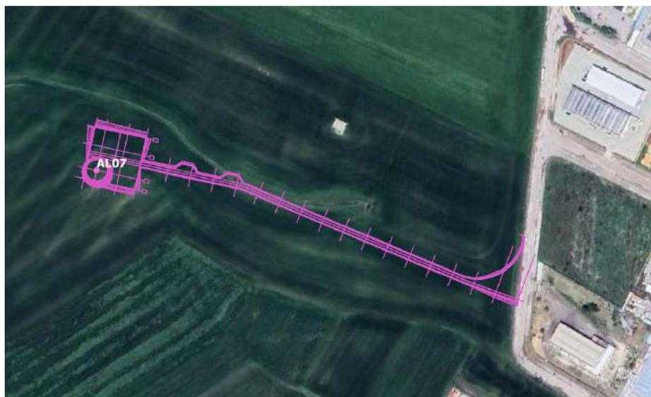
Figura 2-39 Rappresentazione su immagine satellitare dell'impronta a terra della piazzola AL07, e della relativa strada di accesso, nella fase costruttiva
