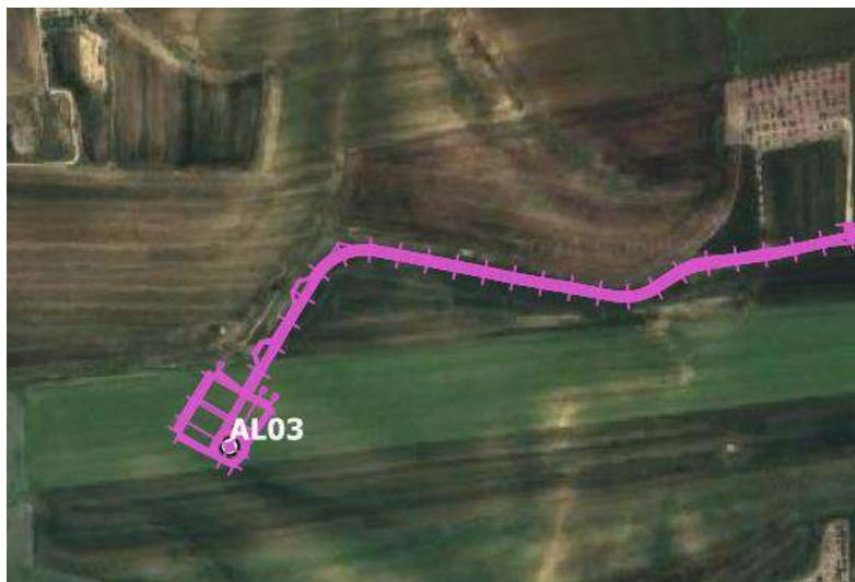
Figura 2-35 Rappresentazione su immagine satellitare dell'impronta a terra della piazzola AL03, e della relativa strada di accesso, nella fase costruttiva
