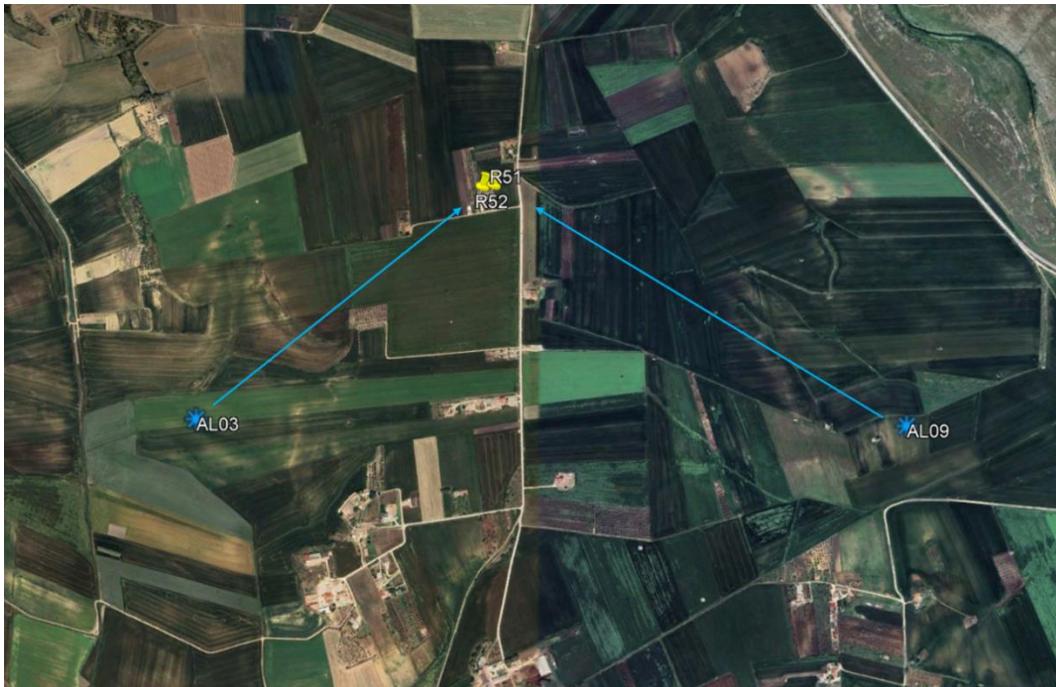
Figura 3-19 Localizzazione recettori R51 e R52 rispetto agli aerogeneratori che causano l'effetto dello shadow flickering
