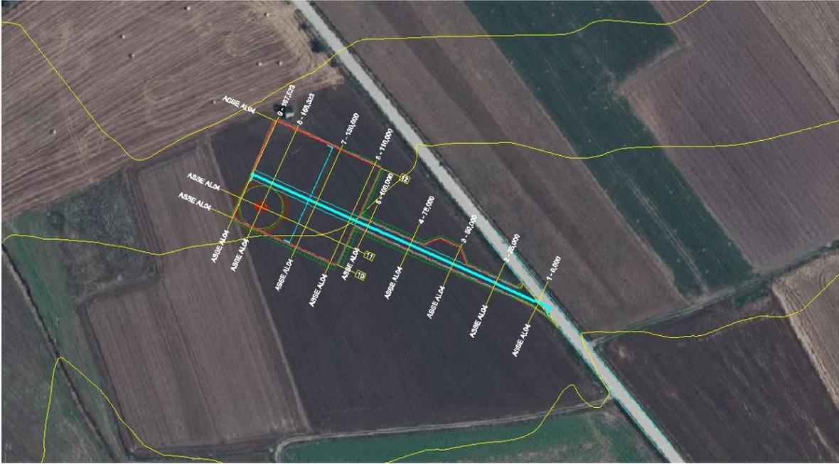
**Piazzola AL05:** Tale piazzola, posizionata a circa 385,80 metri s.l.m., avrà una superficie di circa 3.150 metri quadrati e sarà del tipo a mezza costa con parte Est in scavo (approfondimento massimo pari a circa 2,70 metri) e parte Ovest in rilevato (abbancamento massimo pari a circa 4,00 metri). Tale piazzola sarà ridotta in fase di esercizio a circa 1.200 mq.
