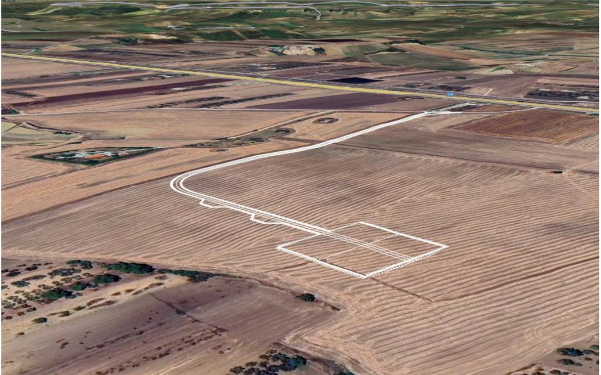
Piazzola AL07: Tale piazzola avrà una superficie di circa 3.200 metri quadrati e, con quota di imposta media di circa 382,20 m s.l.m., sarà del tipo a mezza costa con parte sud in scavo (approfondimento massimo pari a circa 5,20 metri) e parte Nord in rilevato (abbancamento massimo pari circa 5,00 metri). Tale piazzola sarà ridotta in fase di esercizio a circa 1.200 mq.
