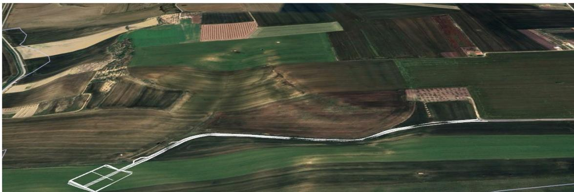
La richiesta conformazione del terreno della sola piazzola determinerà lo scavo di circa 2.000 m<sup>3</sup> di materiale, al netto dello scavo delle strutture di fondazione dell'aerogeneratore (pari a circa 1.000 m<sup>3</sup>) ed il posizionamento in rilevato di circa 4.700 m<sup>3</sup> di materiale oltre a quello impiegato per il rinterro della fondazione.
