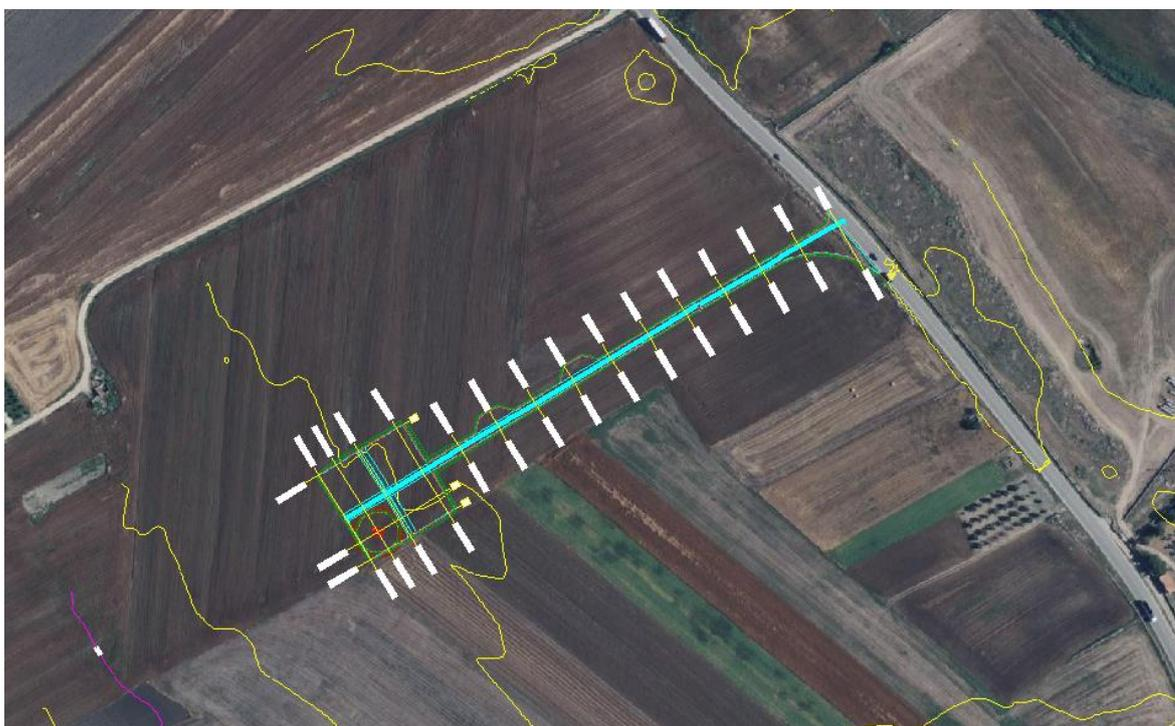
La richiesta conformazione del terreno (sistema piazzola + strada di accesso) determinerà lo scavo di circa 550 m<sup>3</sup> di materiale, al netto dello scavo delle strutture di fondazione dell'aerogeneratore (pari a circa 1.100 m<sup>3</sup>) ed il posizionamento in rilevato di 2.000 m<sup>3</sup> di materiale oltre a quello impiegato per il rinterro della fondazione.
