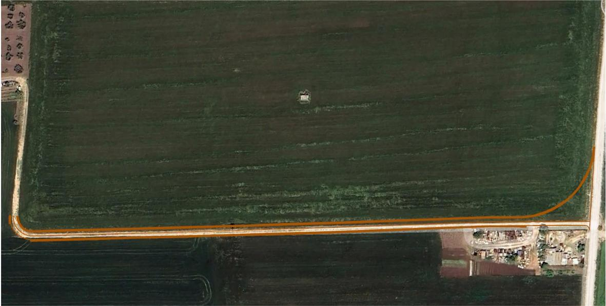
**Asse 02\_AD:** Consiste nell'adeguamento di viabilità interpodereale esistente finalizzato ad avvicinare i convogli all'area di installazione dell'aerogeneratore AL08.
