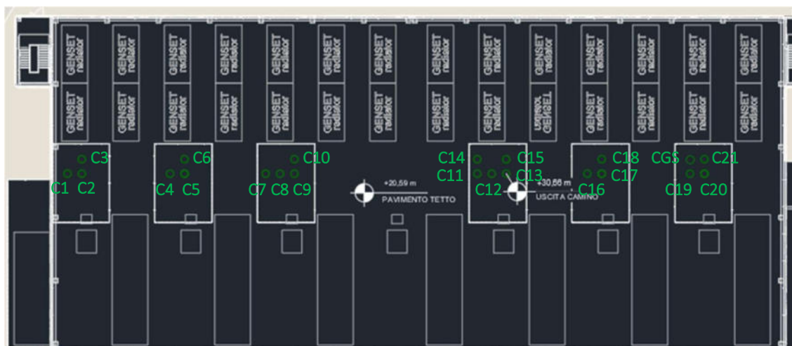
Figura 3.2: Indicazione delle sorgenti emittenti presenti nell'impianto e simulate, indicate e numerate in verde
