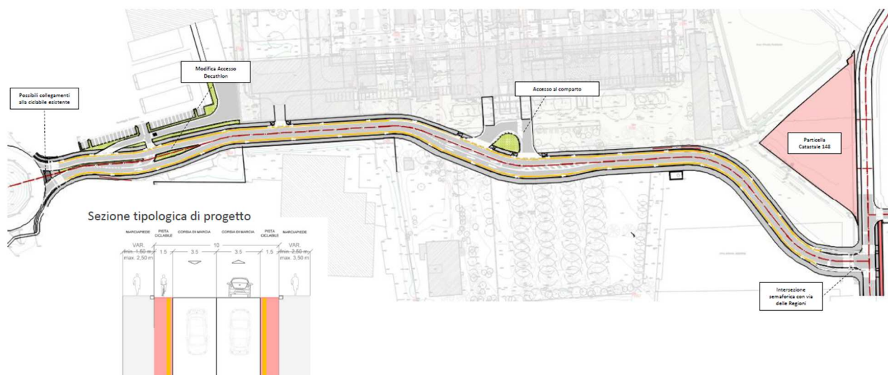
Figura 2.3: Tracciato della Bretella di collegamento
