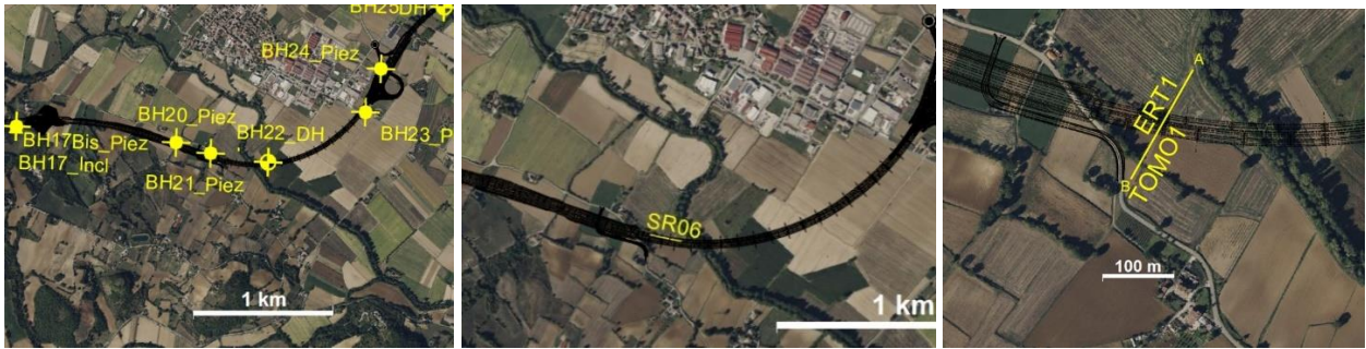
Figura 5-6 Ubicazione delle indagini dirette ed indirette nell'area di interferenza tra l'allineamento tettonico Fighille-Città di Castello e il progetto.
