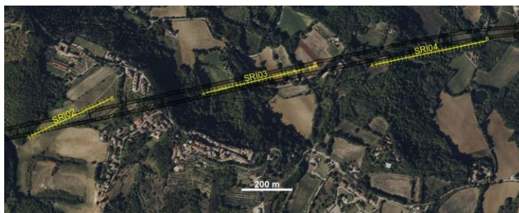
Figura 5-24 Ubicazione degli stendimenti di sismica ibrida a riflessione e rifrazione in onde P, eseguiti lungo l'asse della Galleria Naturale Citerna.
