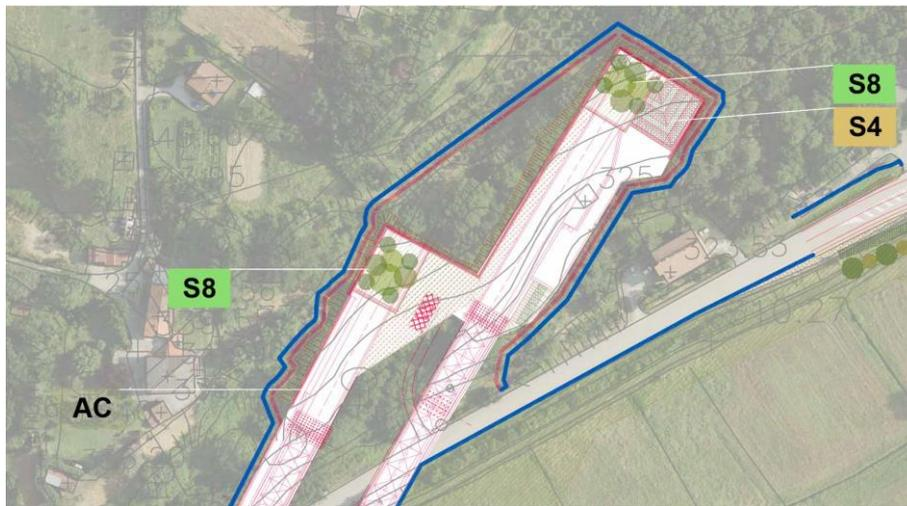
Figura 8-5 Opere di mascheramento e ricucitura presso l'imbocco ovest della galleria Le Ville
