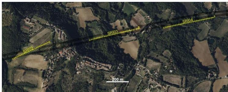
Figura 2.22 Ubicazione degli stendimenti di simica ibrida a riflessione e rifrazione in onde P, eseguiti lungo l'asse della Galleria Naturale Citerna.
