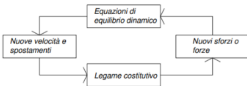
Figura 8-1: Fasi di computazione del codice di calcolo FLAC
