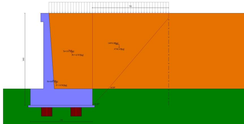
Fig. 27 - Cuneo di spinta (combinazione sismica) (Combinazione n° 2)
