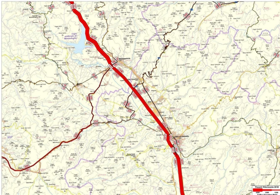
Figura 2.8 Assegnazione veicoli leggeri (verde) e pesanti (rosso) nello scenario di Riferimento – Anno 2018
