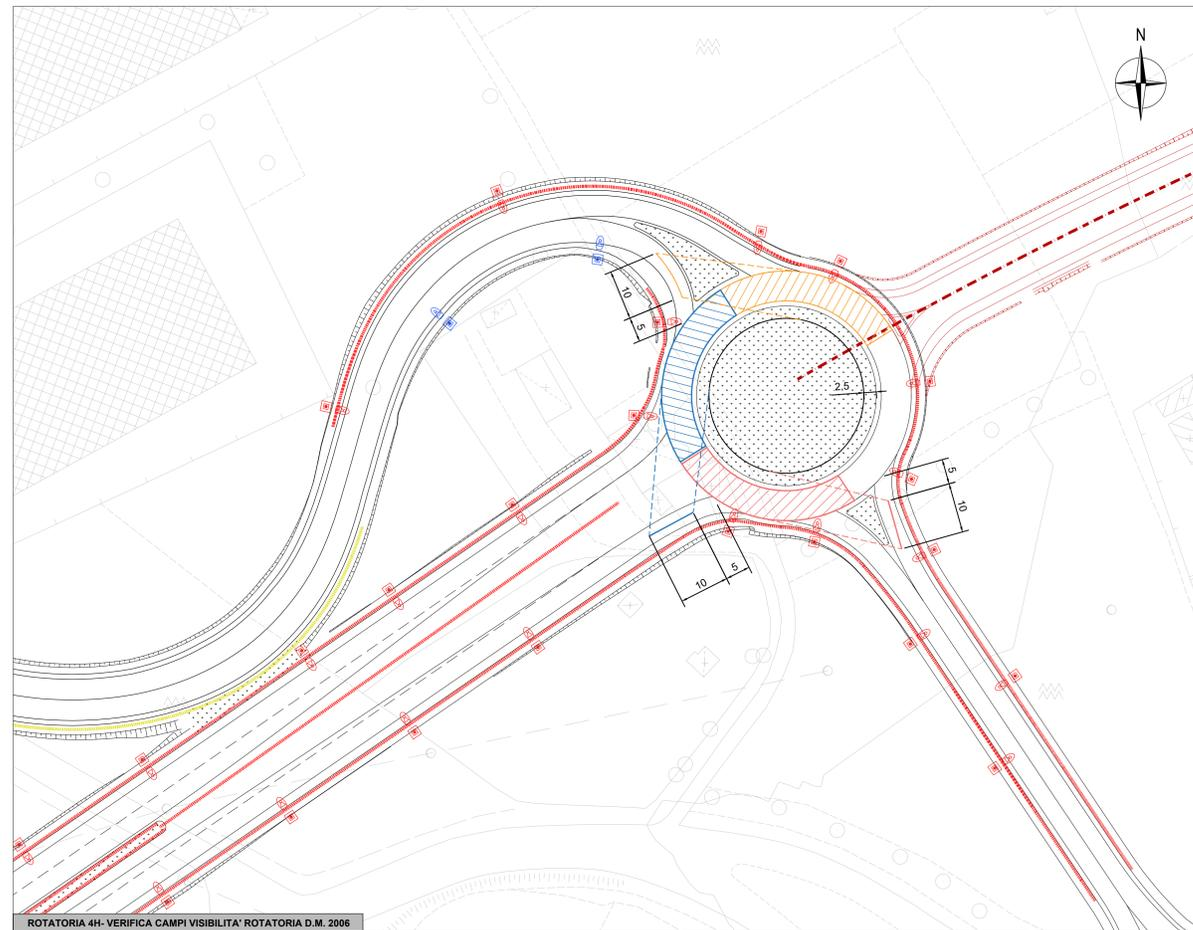
ROTATORIA 4H - VERIFICA CAMPI VISIBILITA' ROTATORIA D.M. 2006
