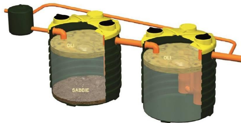
Figura 3-1 Impianto di trattamento in continuo - Particolare 1.
