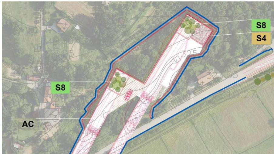
Figura 6-9 – Opere di mascheramento e ricucitura presso l'imbocco ovest della galleria Le Ville
