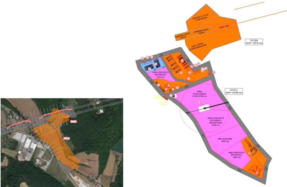
**Figura 5-6 Cantiere CO.01c. E' specifico per la galleria Citerna**
