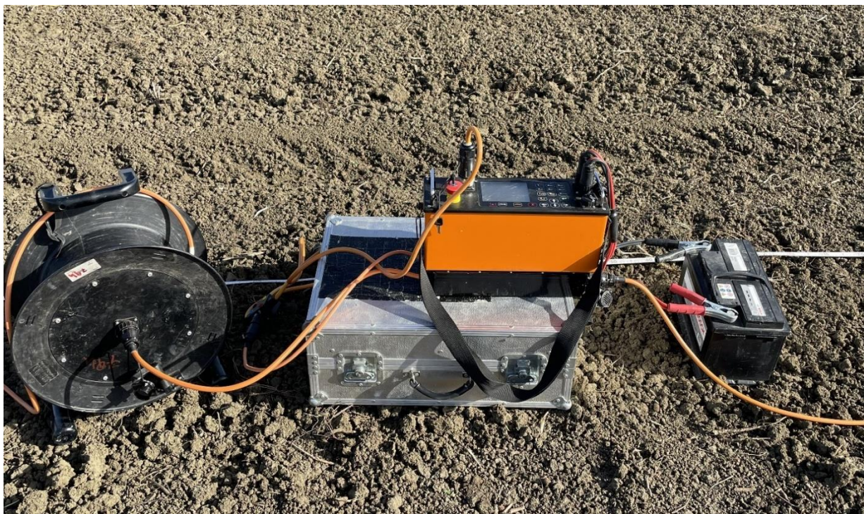
Foto 1 - Georesistivometro ARES II della GF Instruments, utilizzato per le indagini.
