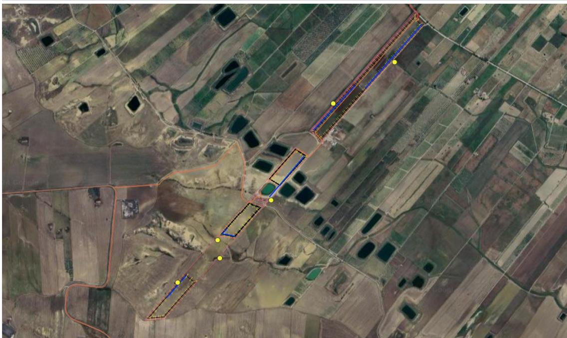
Figura 27. Individuazione e tracciamento trincee di laminazione (in blu) e punti di immissione nei CIR (giallo), Aliai 4
