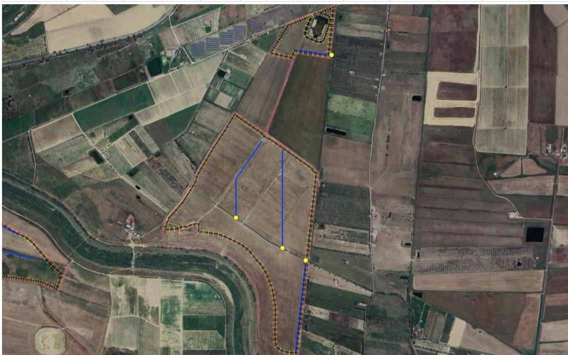
Figura 24. Individuazione e tracciamento trincee di laminazione (in blu) e punti di immissione nei CIR (giallo), Aliai 2
