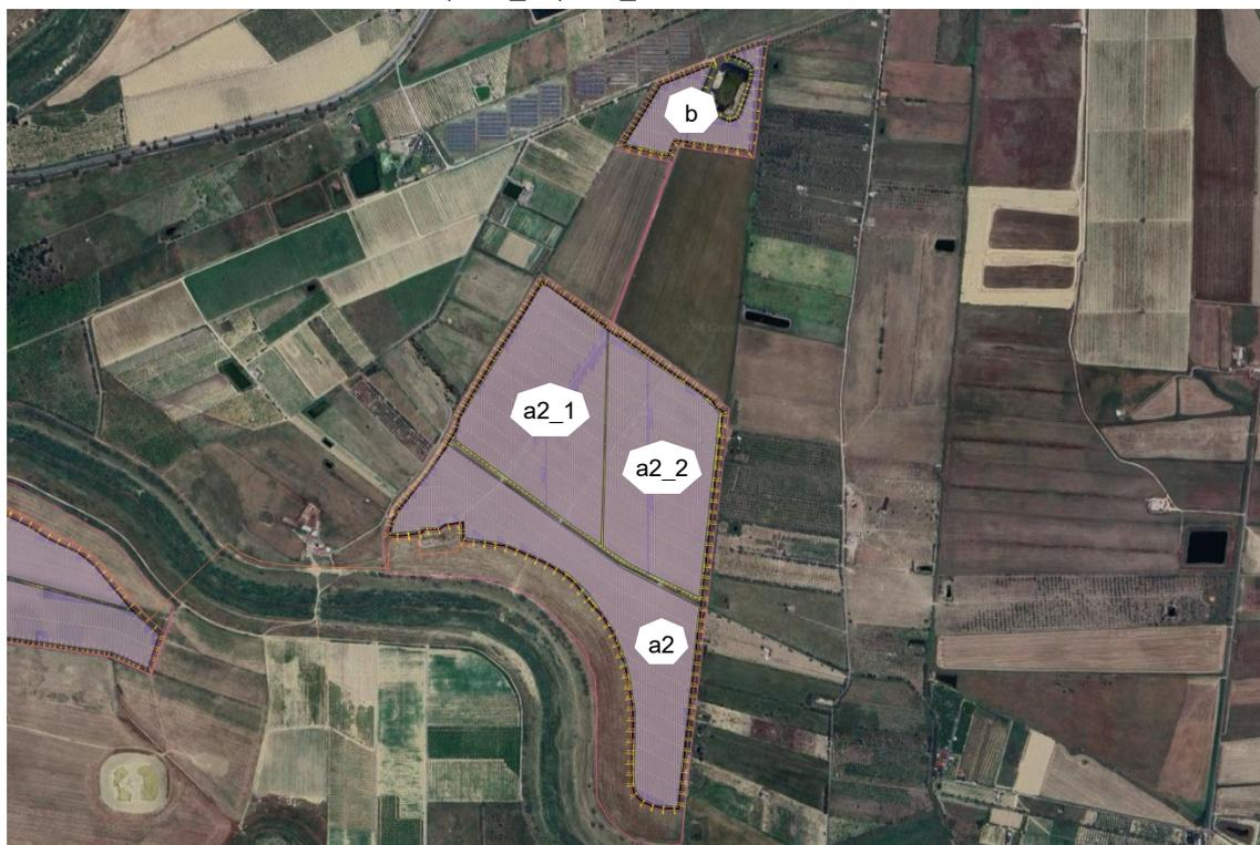
**Figura 4. Individuazione e suddivisione del campo fotovoltaico “Aliai 2” in sottocampi (ai fini delle verifiche idrauliche)**
