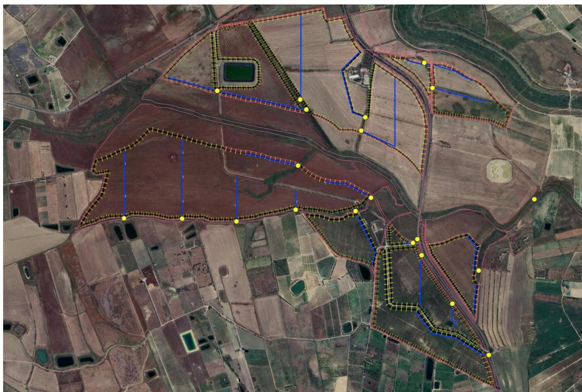
**Figura 22. Individuazione e tracciamento trincee di laminazione e indicazione dei punti di immissione nei CIR, Aliai1**
