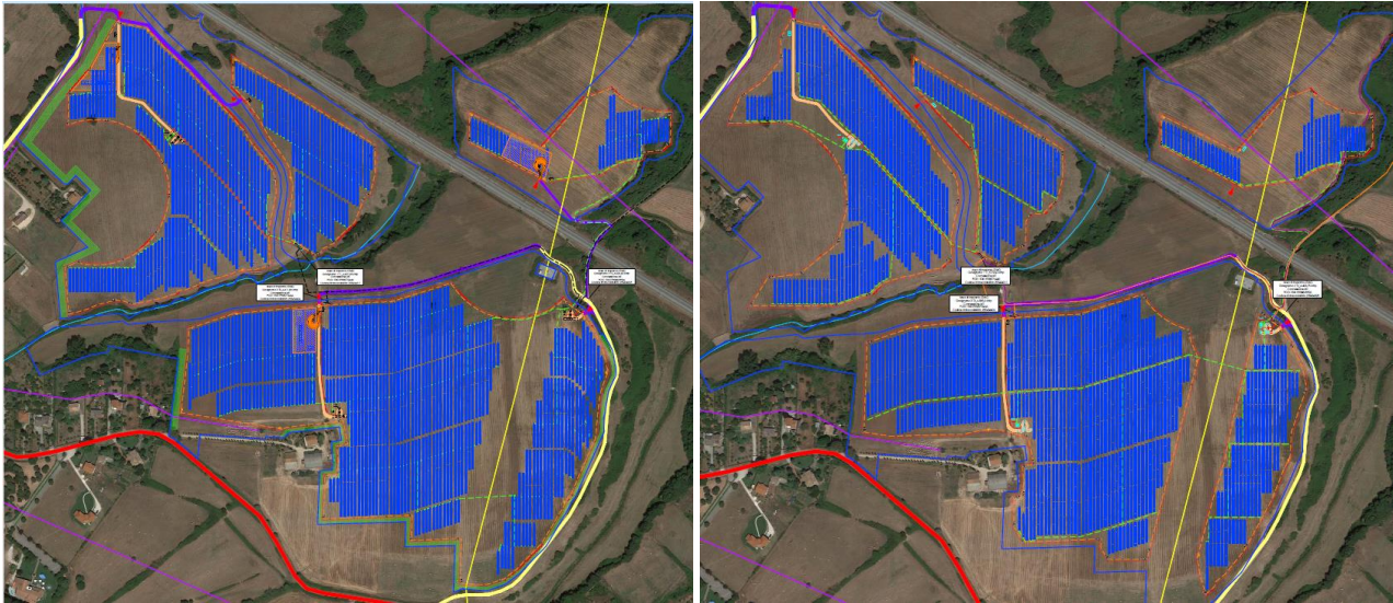
Fig. 18 - Confronto tra la disposizione dei tracker tra il LAYOUT presentato nell'istanza (a sinistra) e quello in integrazione (a destra)
