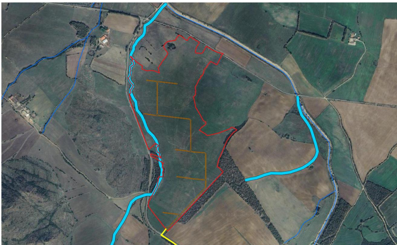
Figura 4: Planimetria di progetto su ortofoto con individuazione del reticolo idrografico della Regione e delle fasce di rispetto Strahler (evidenziate in giallo).
