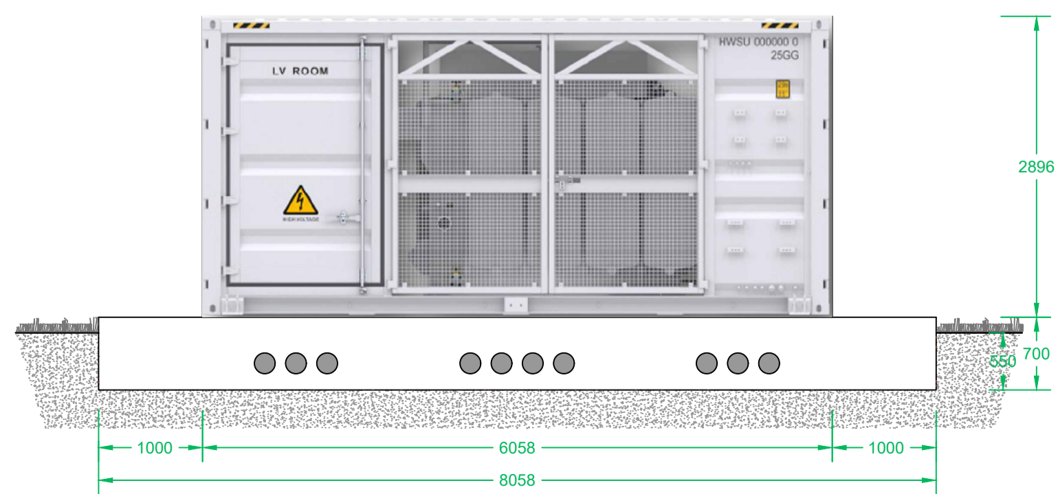
CABINA DI RACCOLTA: Prospetto frontale
