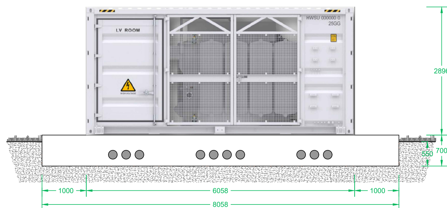
CABINA DI RACCOLTA: Prospetto frontale
