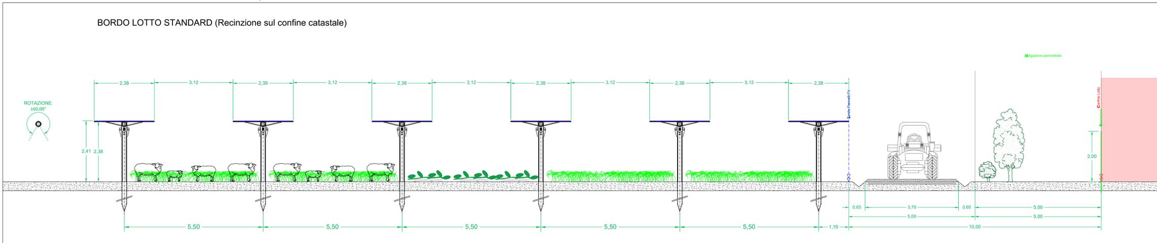
SEZIONE TIPO - PARTICOLARE COLTIVAZIONI INTERFILARE: Pannelli in rotazione e recinzione su bordo lotto - SCALA 1:50
