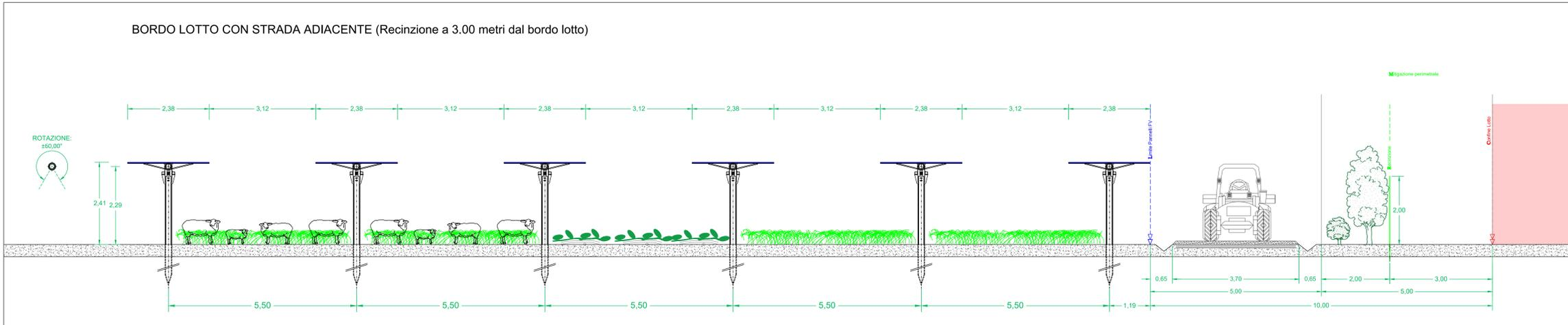
SEZIONE TIPO - PARTICOLARE COLTIVAZIONI INTERFILARE: Pannelli in posizione orizzontale e recinzione con distacco dal confine stradale - SCALA 1:50
