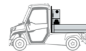
Modulo cleaning con idropulitrice
