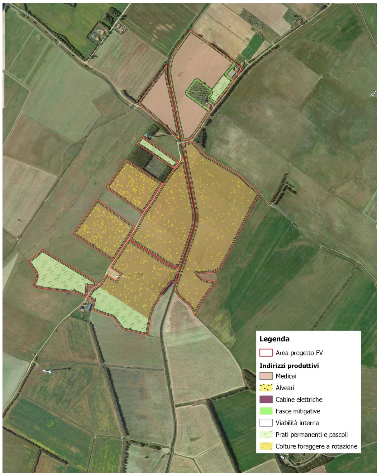
Figura 40 - Planimetria dell'uso del suolo e delle misure mitigative ad indirizzo produttivo proposte
