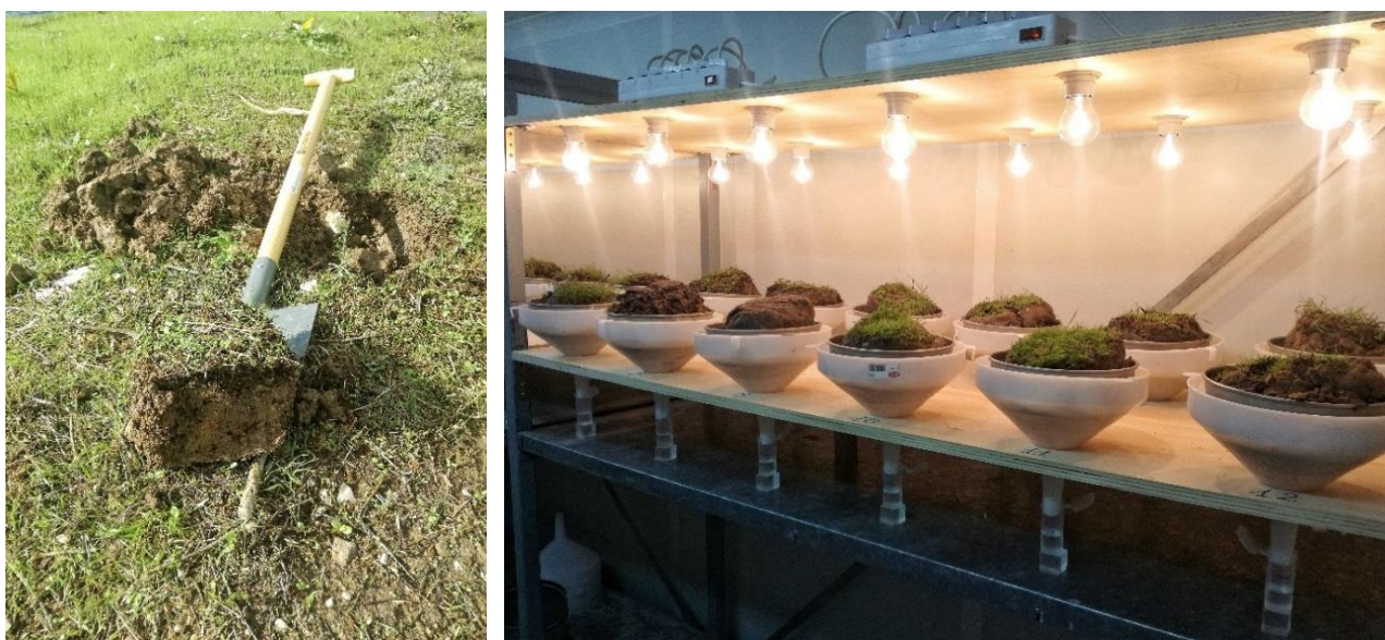
Figura 41 A sinistra fasi di prelievo di una zolla di terra per l'analisi del QBS-ar, a destra fase di essiccazione delle zolle e cattura dei microartropodi.
