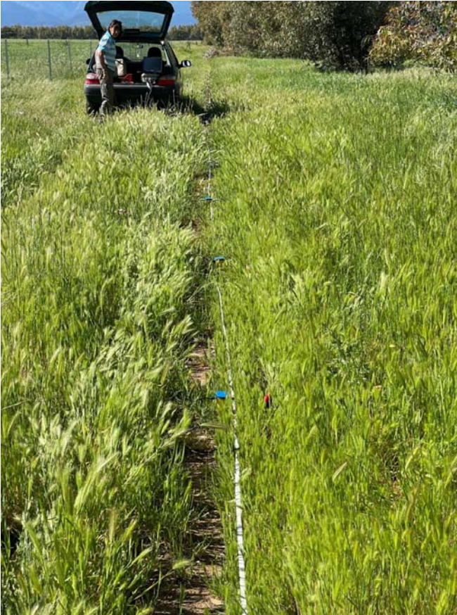
Foto n. 3 L'allineamento dei geofoni visto dal geofono A1 (lato ingresso).
