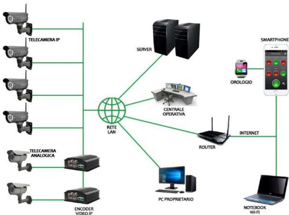
Si prevede la realizzazione di una sala Controllo in grado di visualizzare le immagini del Sistema di Videosorveglianza, che potrà essere ubicata un vano della Cabina di Raccolta Generale ma che potrà essere anche dislocata in remoto. La suddetta sala disporrà delle apparecchiature necessarie a garantire la visualizzazione dei flussi Video e l'accesso alle registrazioni .
