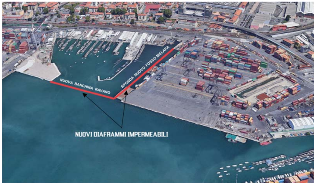
Figura 3.2 – Configurazione nuovi diaframmi impermeabili
