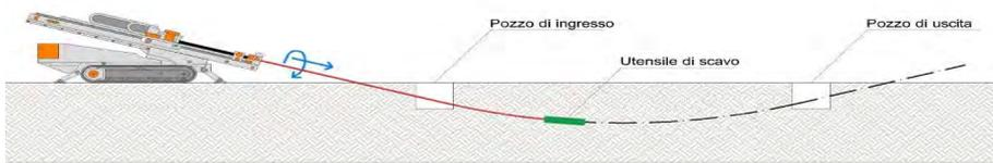
2) Perforazione pilota (pilot bore): mediante una macchina operatrice si realizza una perforazione normalmente di piccolo diametro che viene manovrata attraverso la combinazione di rotazioni e spinte il cui effetto, sulla traiettoria seguita dall'utensile di scavo, è controllata attraverso un sistema di guida radiocollato. La perforazione pilota può seguire percorsi plano-altimetrici preassegnati che possono contenere anche tratti curvilinei.
