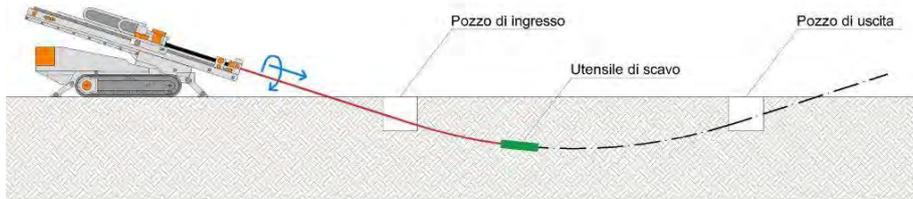
2) Perforazione pilota (pilot bore): mediante una macchina operatrice si realizza una perforazione normalmente di piccolo diametro che viene manovrata attraverso la combinazione di rotazioni e spinte il cui effetto, sulla traiettoria seguita dall'utensile di scavo, è controllata attraverso un sistema di guida radiocontrollato. La perforazione pilota può seguire percorsi plano-altimetrici preassegnati che possono contenere anche tratti curvilinei.
